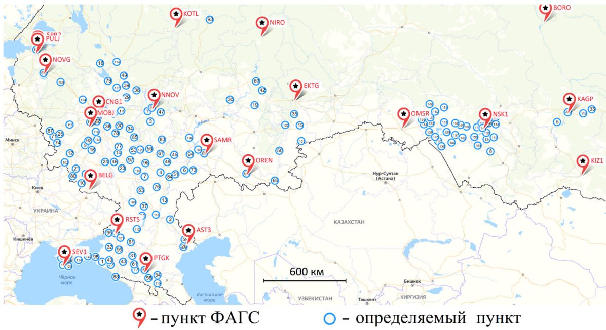
Рисунок 4 – Фрагмент карты с опорными и определяемыми пунктами
