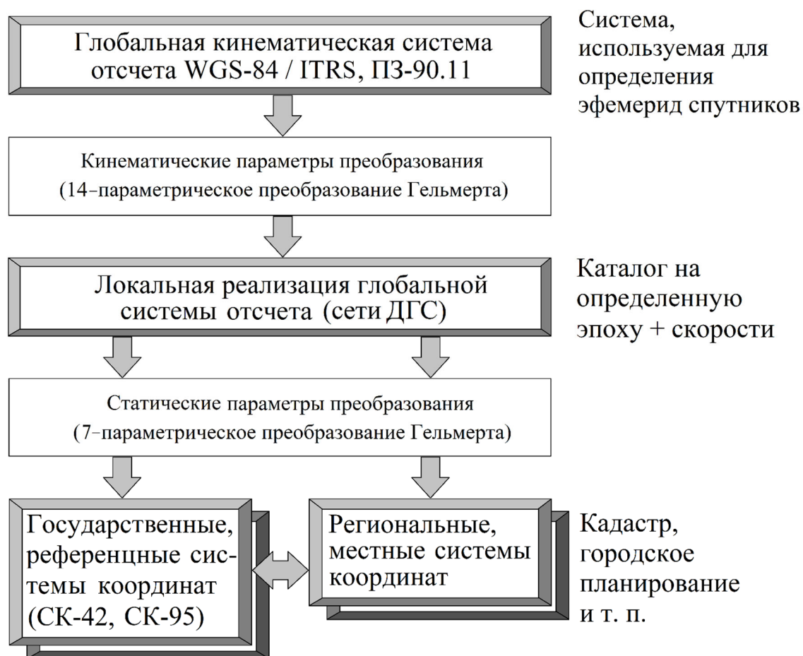
Рисунок 2 – Уточненная схема связи систем отсчета и систем координат
