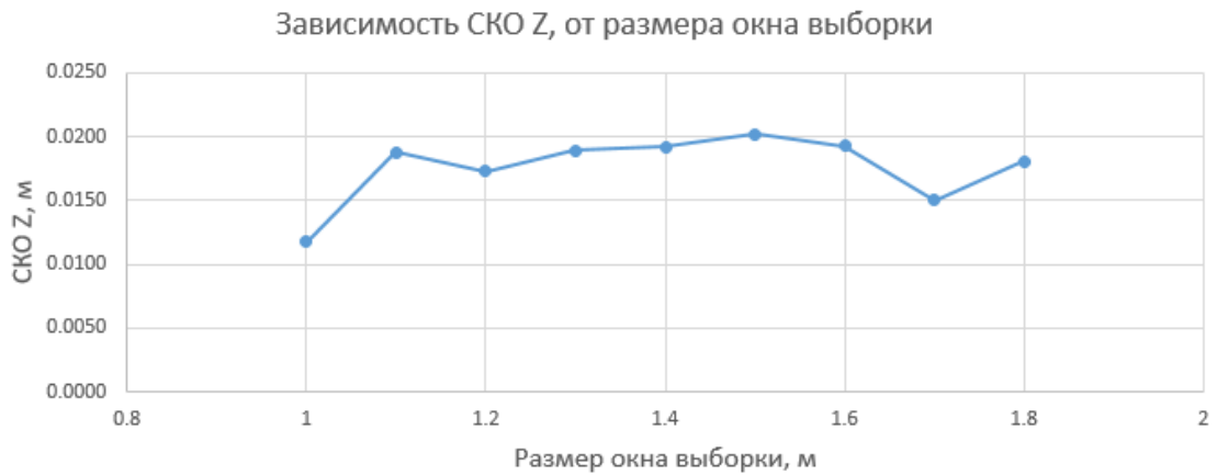
Рисунок 3.11 – Зависимость точности интерполирования от размера выборки (поверхность 4)
