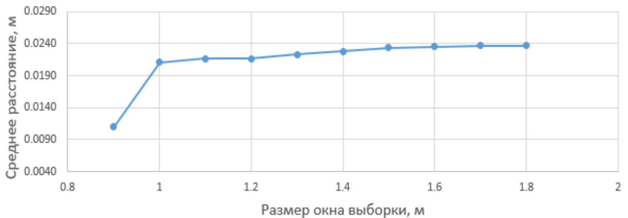
Рисунок Б.5 – Зависимость среднего расстояния от плоскости, в зависимости от размера окна выборки (поверхность 3)
