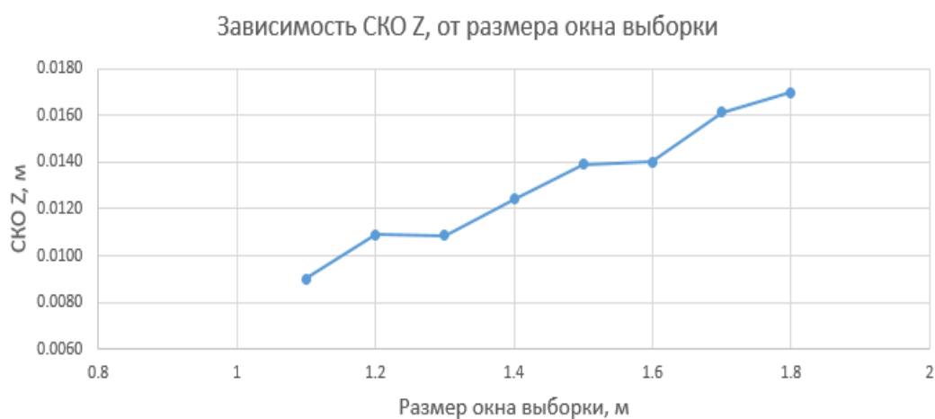
Рисунок 3.9 – Зависимость точности интерполирования от размера выборки (поверхность 2)
