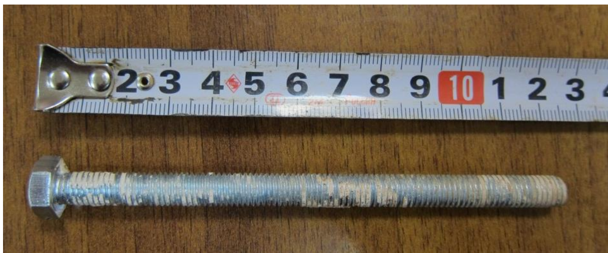
Рисунок 4.11 - Конструкция осадочных марок
