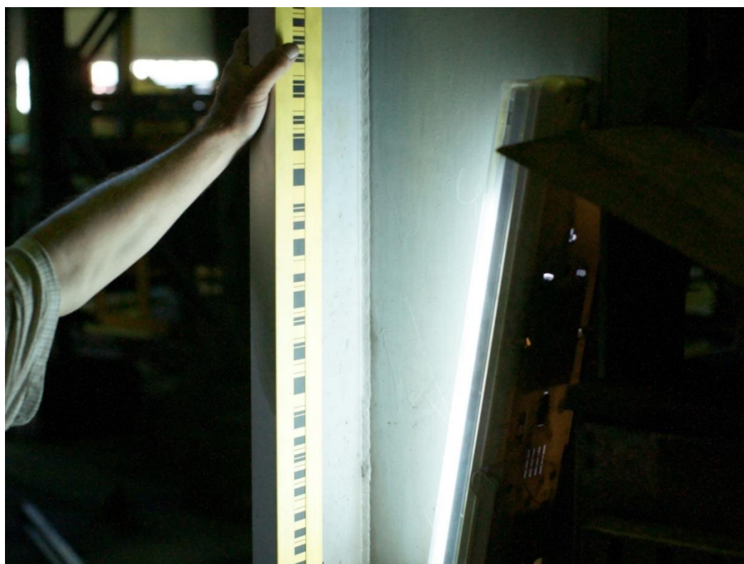
Рисунок 4.5 – Штрихкодová рейка в условиях недостаточной освещенности
