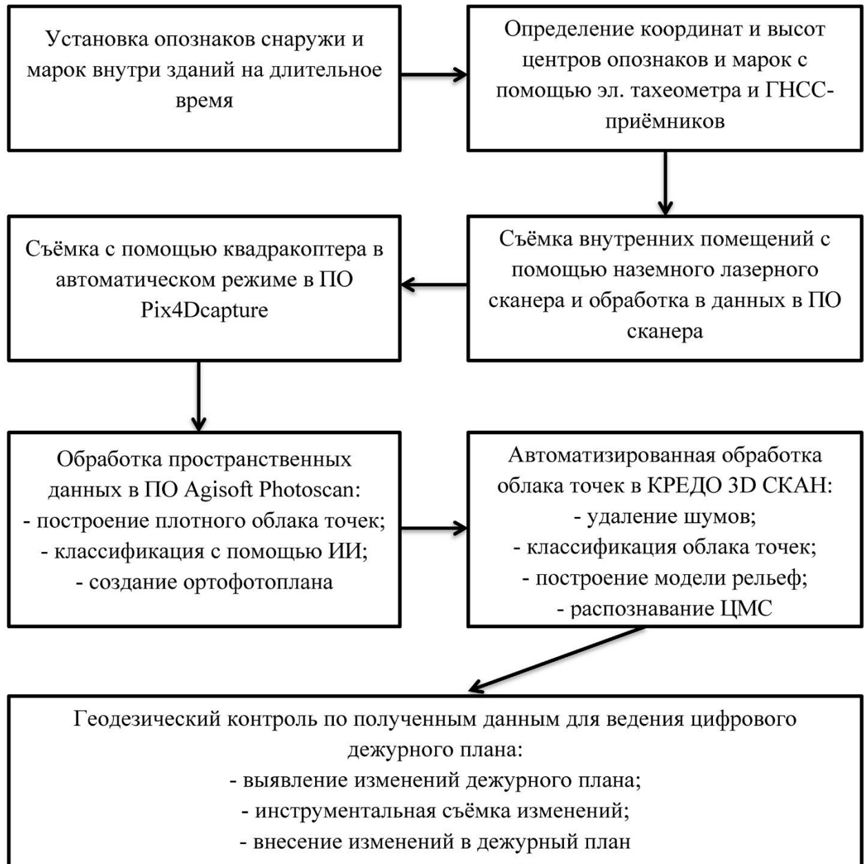
Рисунок 2.16 - Схема работы на объекте для ведения цифрового дежурного плана
