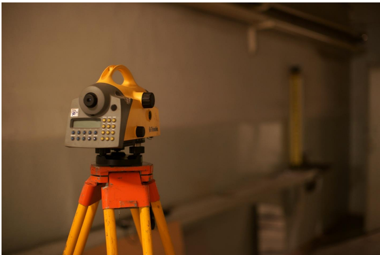
Рисунок 3.5 - Исследование цифрового нивелира в лабораторных условиях
