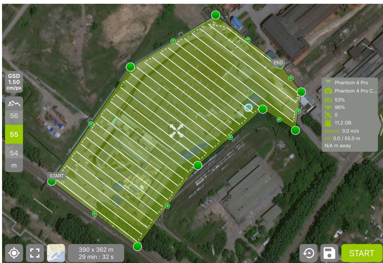
Рисунок 2.17 - Создание маршрута полета квадрокоптера в ПО Pix4Dcapture
