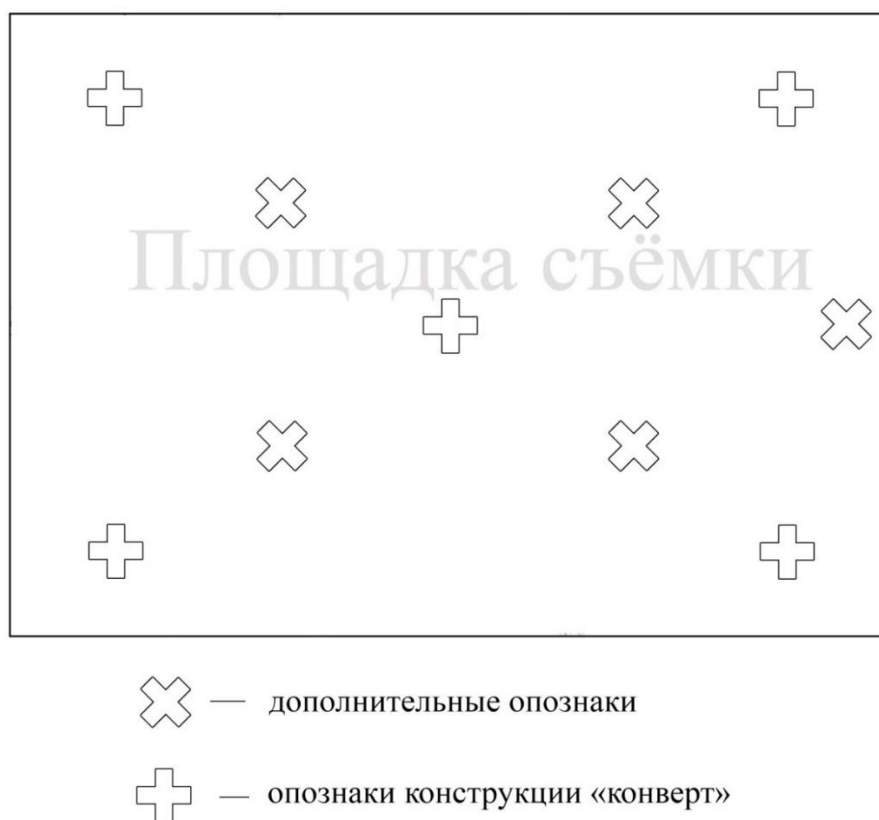
Рисунок 2.2 - Схема расположения опознаков на площадном объекте до 1 кв. км
