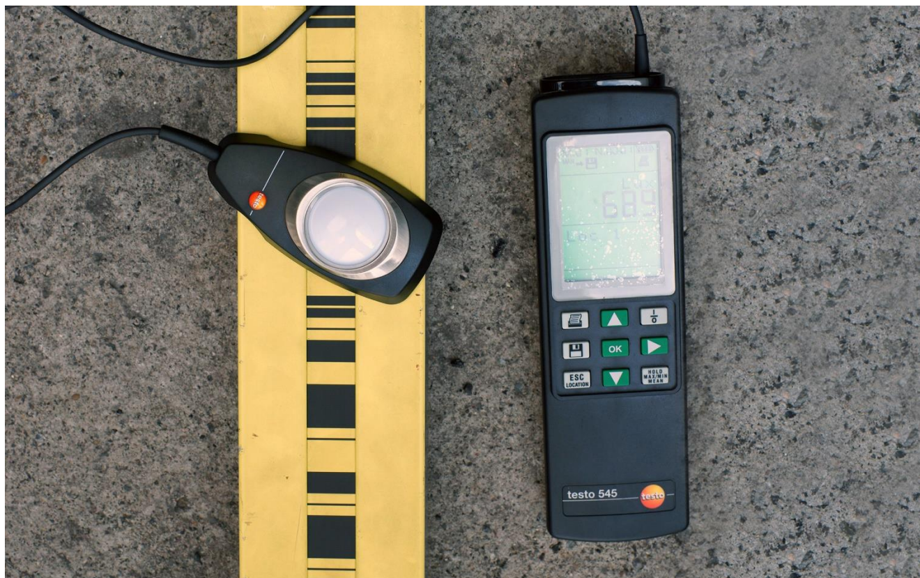
Рисунок 3.4 - Цифровой люксметр testo 545 и инварная штрихкодová рейка
