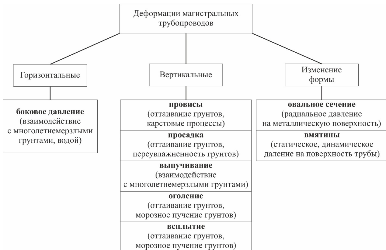
Рисунок 3 – Классификация деформаций магистральных трубопроводов для целей геодезического мониторинга
