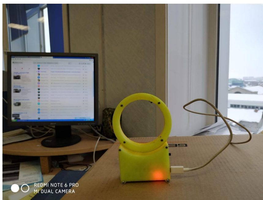
Рисунок 49 – Светодиодная съемная насадка в режиме зарядки аккумулятора [57, 68]
