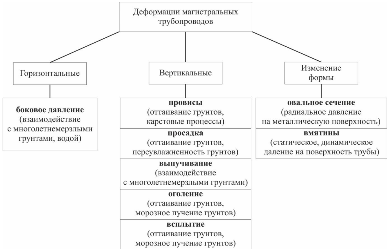
Рисунок 15 – Классификация деформаций магистральных трубопроводов для целей геодезического мониторинга
