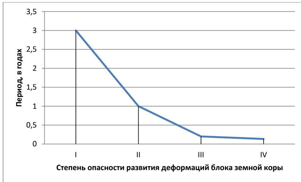
Рисунок 3.33 – Связь периода наблюдений со степенью опасности развития деформаций блока земной коры
