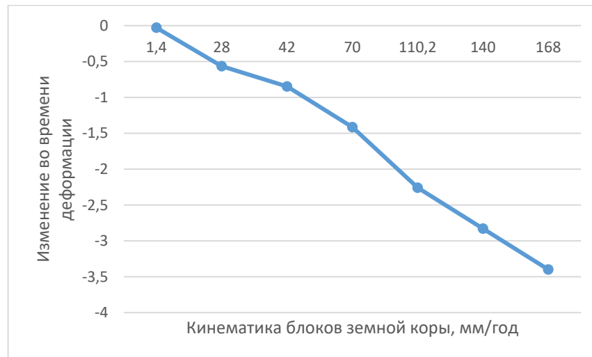
Рисунок 2.10 – Зависимость изменения во времени деформации ( 1 \cdot 10^{-6} ) блока земной коры 489 II ранга Кузбасса от скорости его движения (мм/год)
