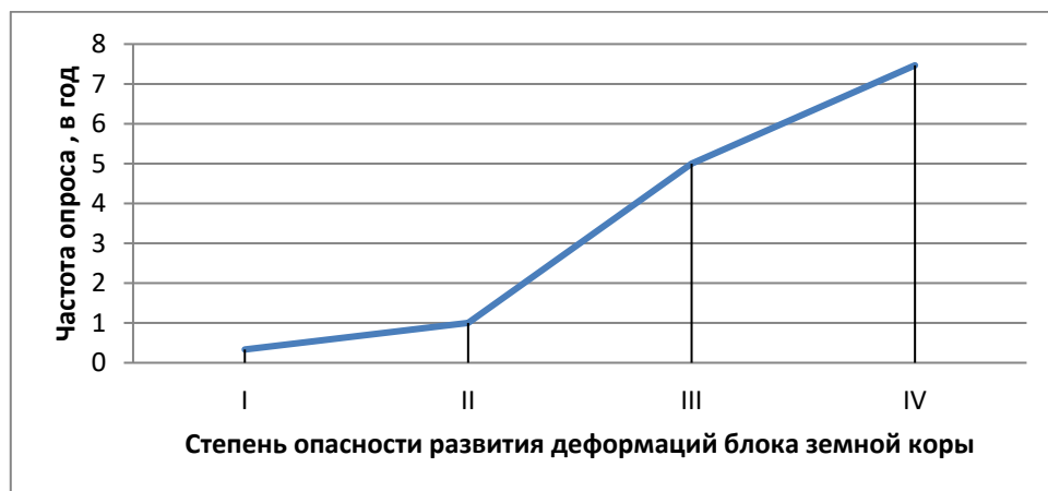
Рисунок 3.34 – Связь частоты опроса со степенью опасности развития деформаций блока земной коры
