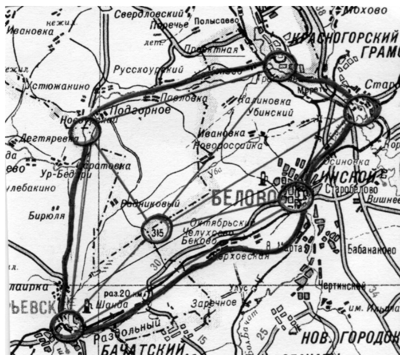
Рисунок 2.26 – Схема расположения пунктов ГДП блока земной коры III ранга
