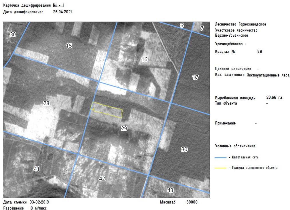
Рисунок 4.8 – Пример сформированного картографического материала с подложкой на основе красного канала (B4) снимка Sentinel-2
