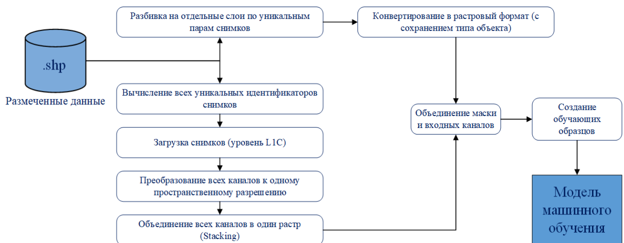
Рисунок 3.8 – Общая схема процесса предварительной обработки снимков
