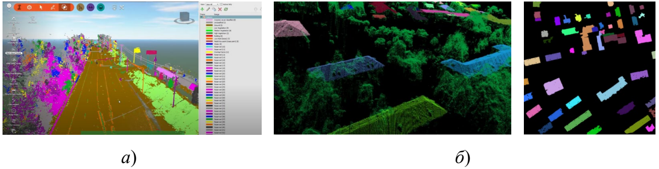
Рисунок 3.4 – Автоматизированные классификация, оконтуривание и аппроксимация (выравнивание) объектов на основе облаков точек
