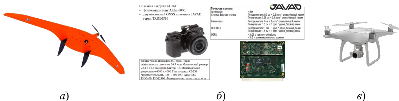
Рисунок 4.1 – Беспилотный летательный аппарат Supercam S350 (а), аэрофотогеодезическое оборудование на борту Supercam S350 (б), БПЛА Phantom Professional 4 (в)
