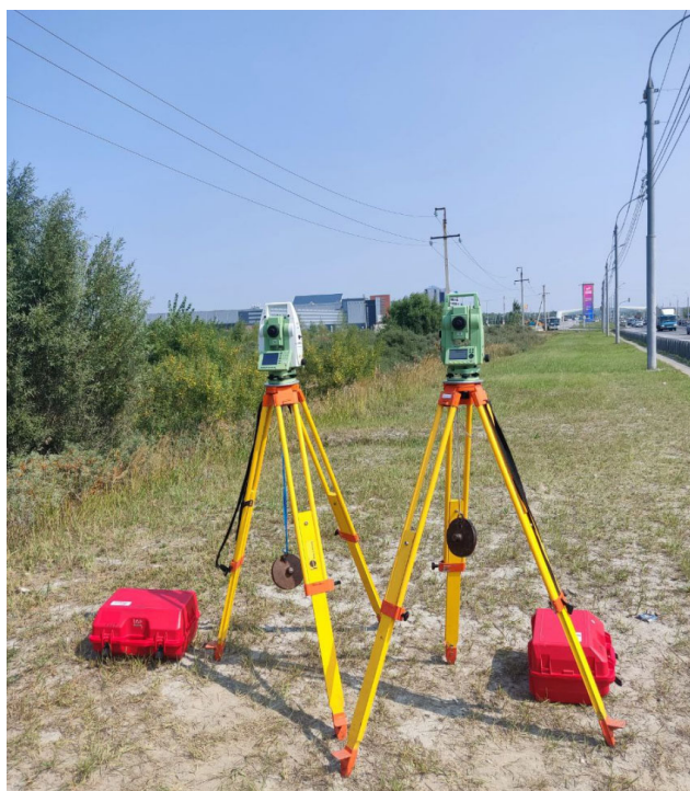
Рисунок 3.12 – Схема установки эталонного и поверяемого тахеометров
