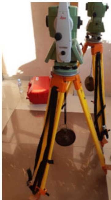
Рисунок 2.16 – Пример установки тахеометров на бетонное основание для выполнения поверки
