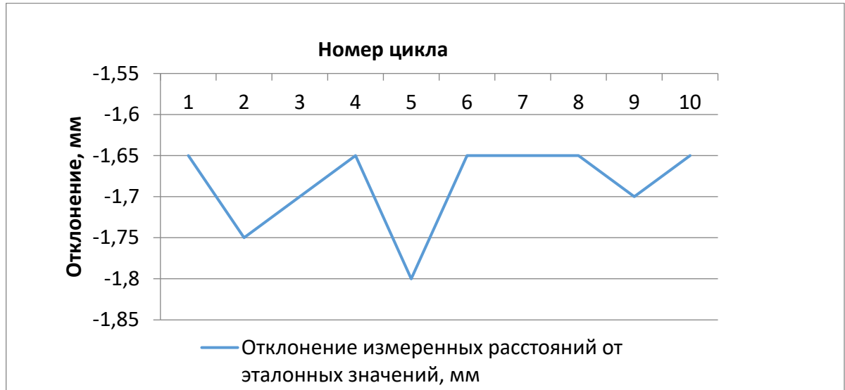
Рисунок 2.17 – График отклонений измеренных расстояний от эталонных значений
