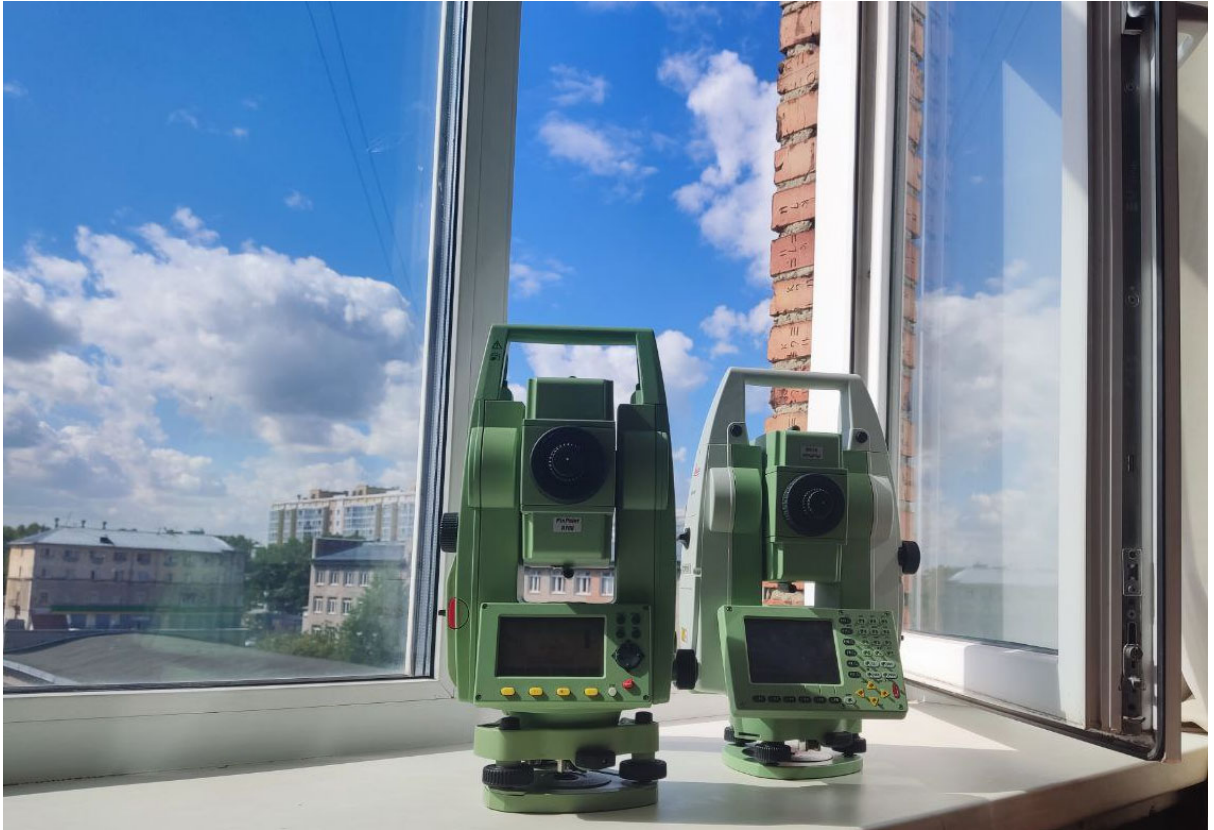
Рисунок 2.20 – Схема установки тахеометров на подоконник
