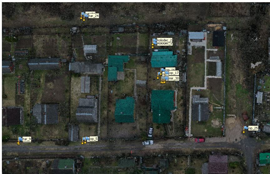
Рисунок 3.7 – Схема расположения опознаков на территории ИЖС
