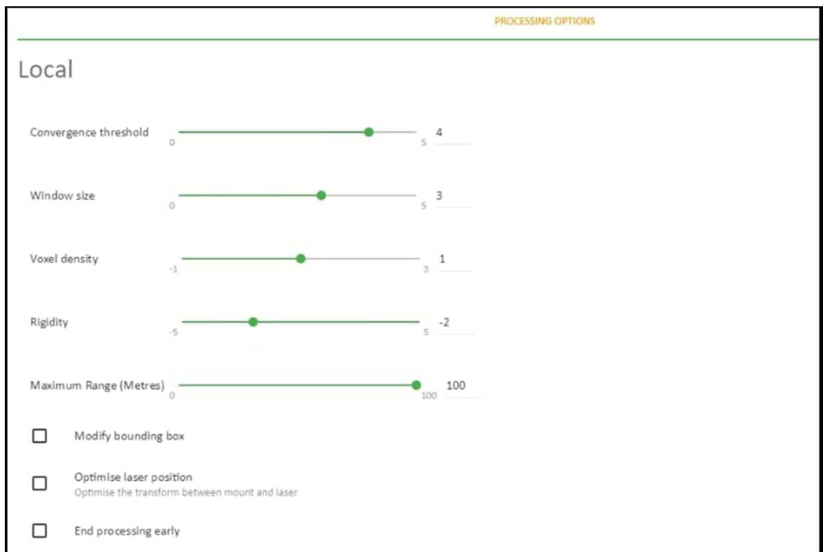
Рисунок 3.19 – Окно выбора параметров мобильного сканирования в ПО GeoSLAMHub
