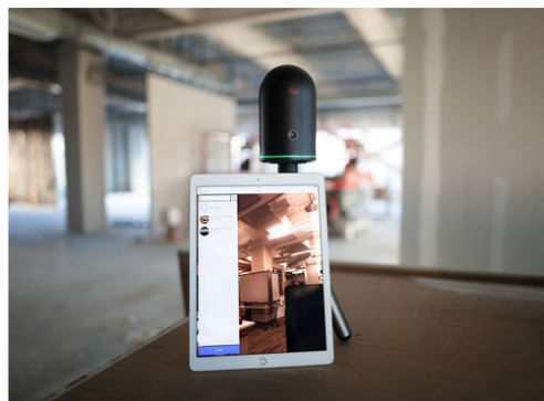
Рисунок 3.9 – Технические характеристики наземного лазерного сканера BLK 360
