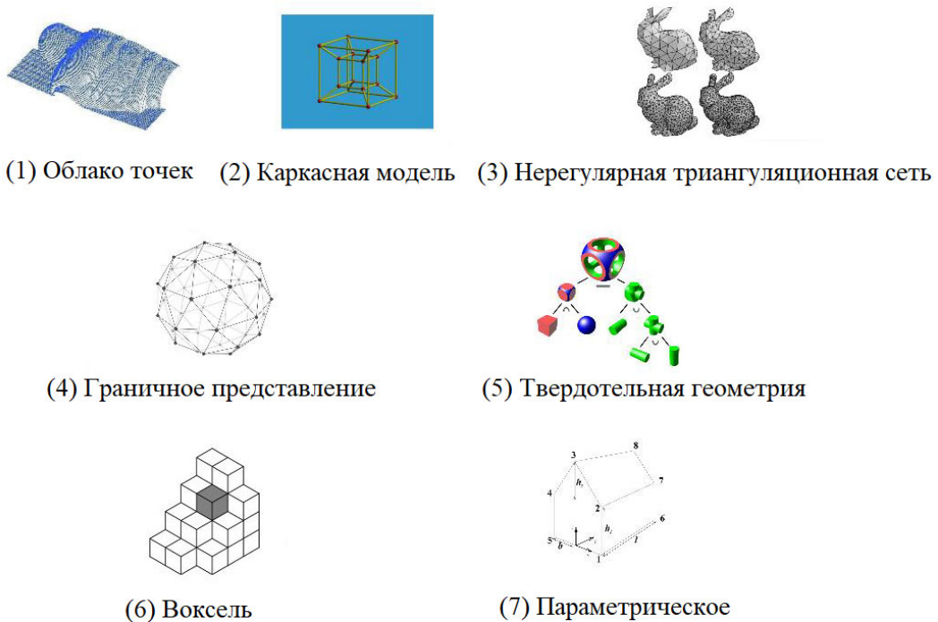
Рисунок 2.8 – Примеры геометрических методов моделирования (адаптировано из работы [210])
