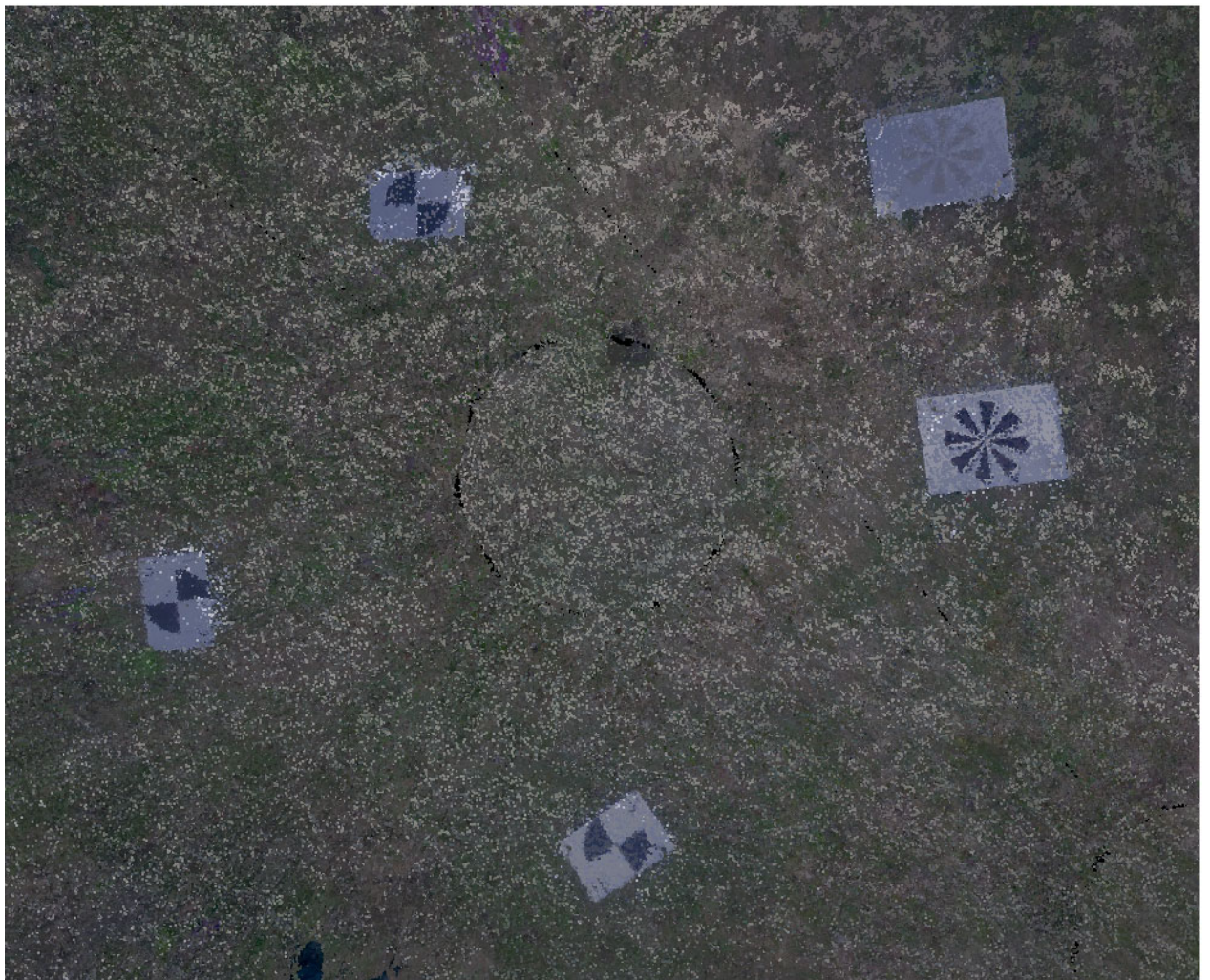
Рисунок 3.15 – Вид связующих опознаков на облаке точек
