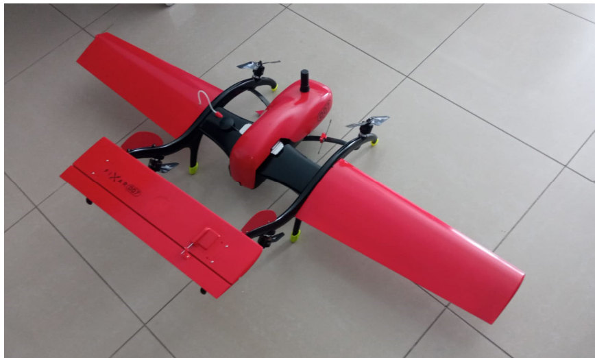
Рисунок 5 – БВС гибридного типа
