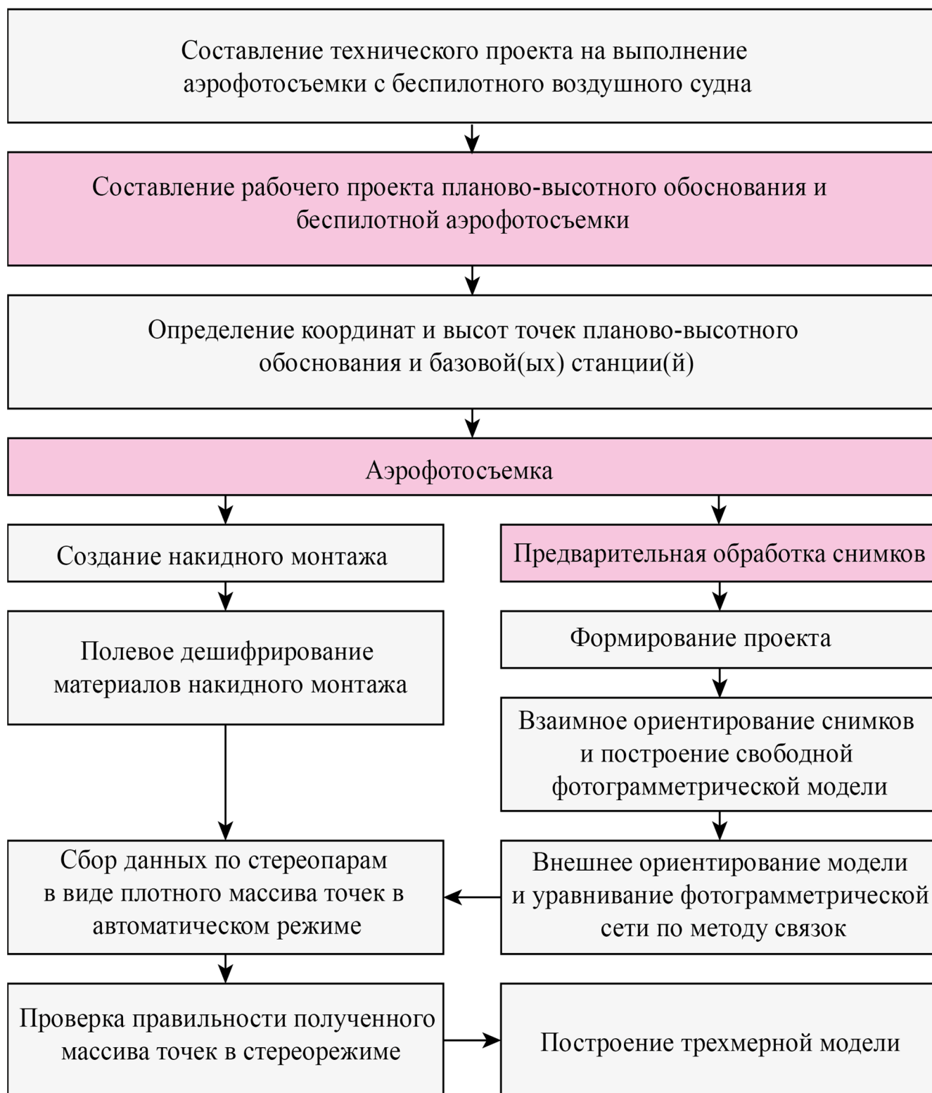
Рисунок 37 – Схема усовершенствованной методики обработки материалов аэрофотосъемки с беспилотных воздушных судов для трехмерного моделирования территорий
