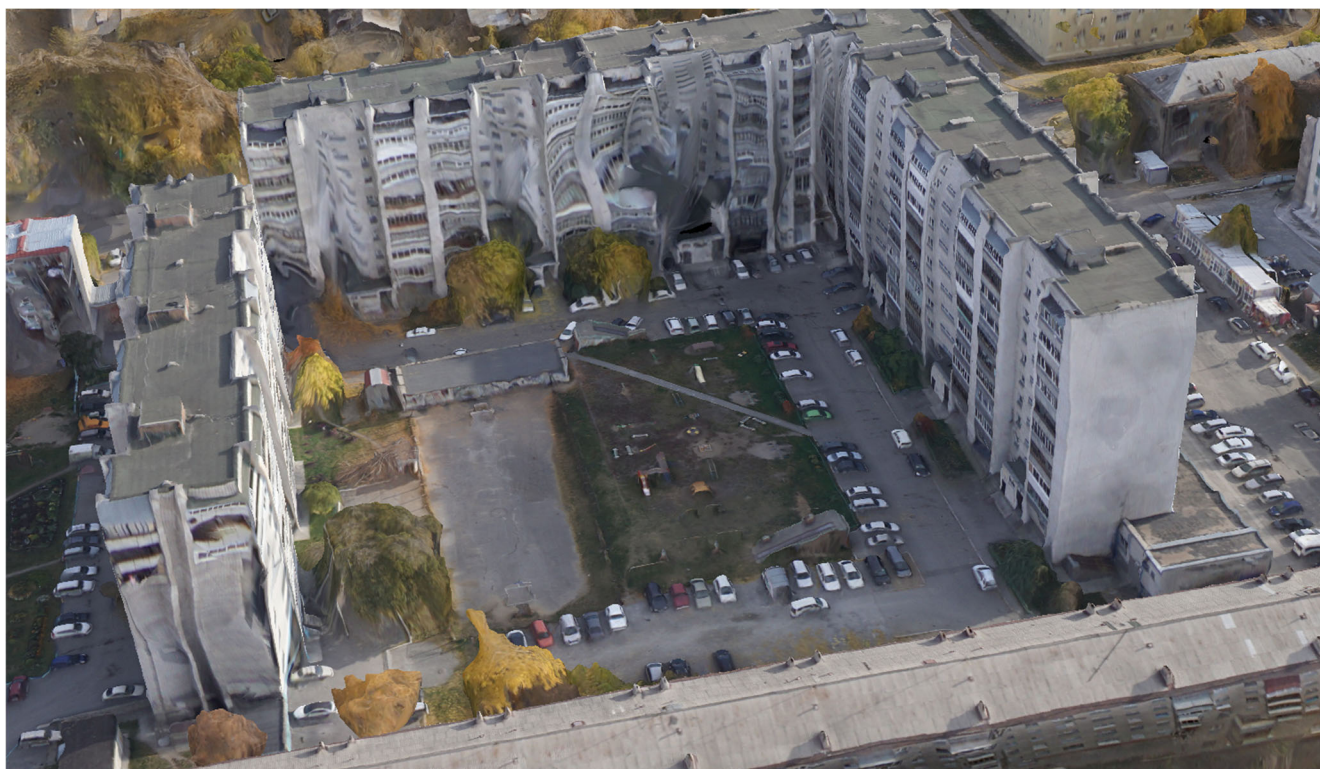
Рисунок 49 – Трехмерная модель территории, построенная в ходе обработки аэрофотосъемки с маршрутами в направлении А
