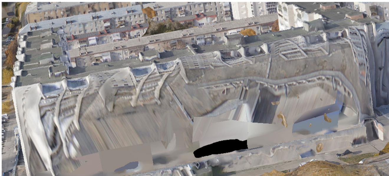
Рисунок 50 – Трехмерная модель территории с дефектами текстурирования
