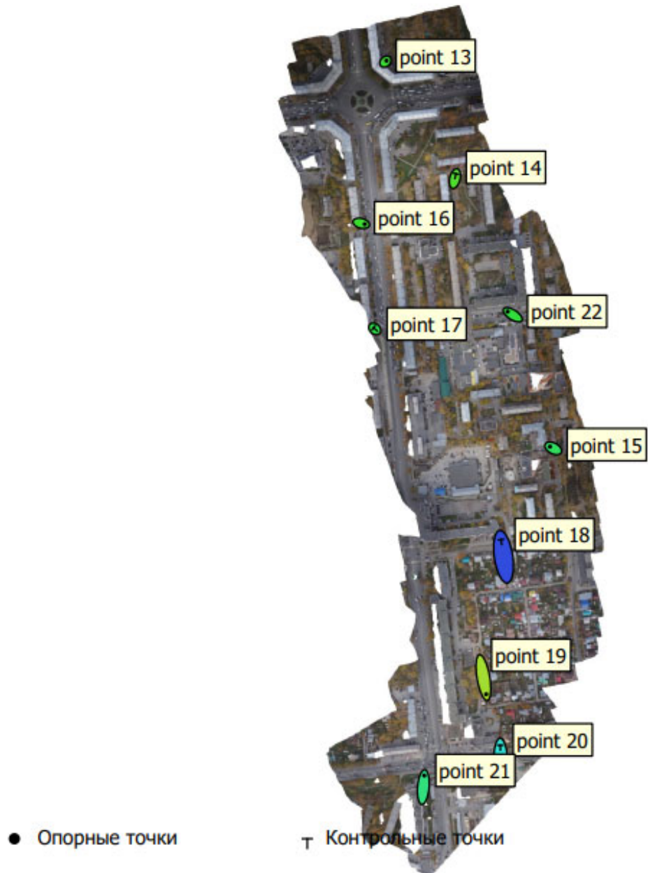
Рисунок 29 – Схема расположения опорных и контрольных точек участка аэрофотосъемки
