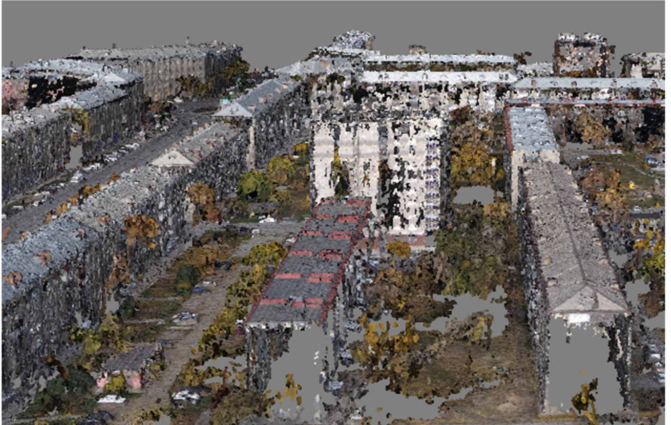
Рисунок 17 – Трехмерная модель в виде плотного массива точек
