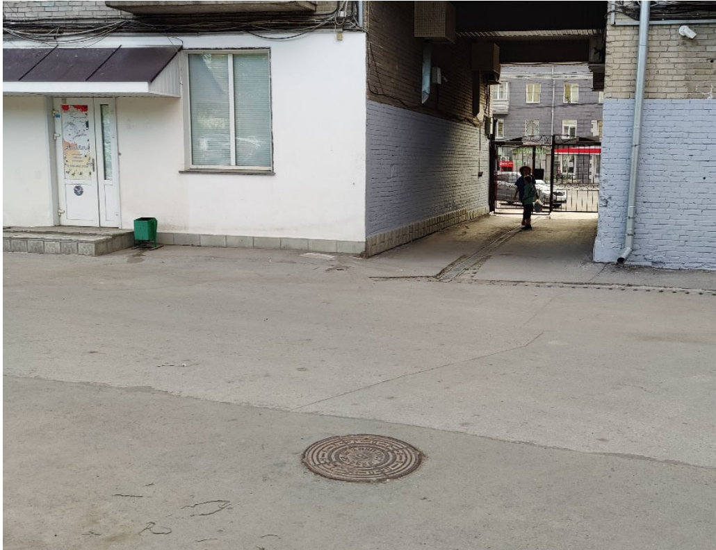
Рисунок 41 – Центр люка смотрового колодца в качестве опознака на местности
