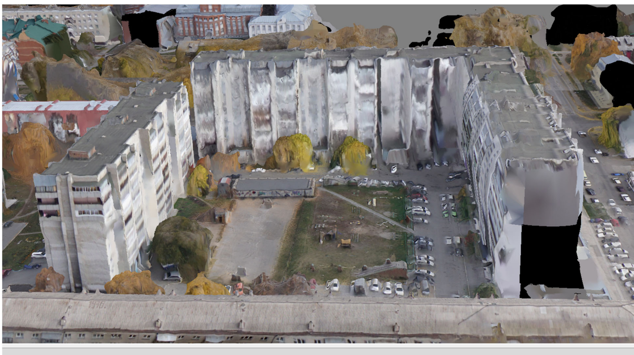
Рисунок 52 – Трехмерная модель территории, полученная в результате фотограмметрической обработки снимков
