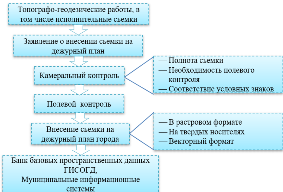
Рисунок 17 – Порядок актуализации дежурного топографического плана города
