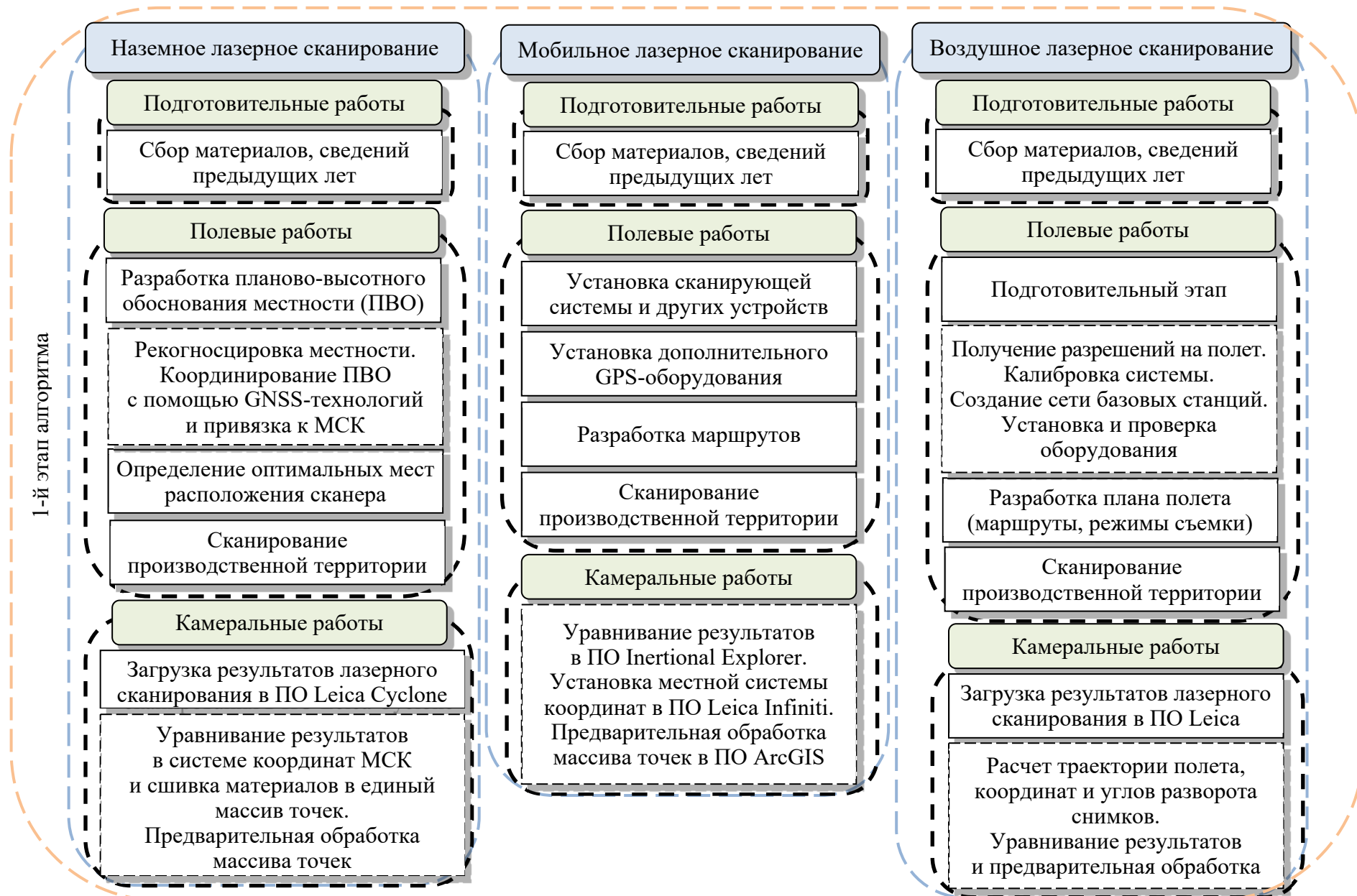
Рисунок 12 – Первый этап алгоритма формирования 3D-модели линейных инженерных сооружений
