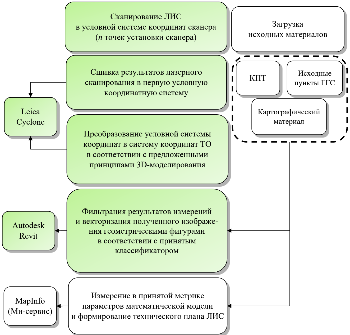
Рисунок 11 – Предлагаемый алгоритм формирования 3D-модели ЛИС
