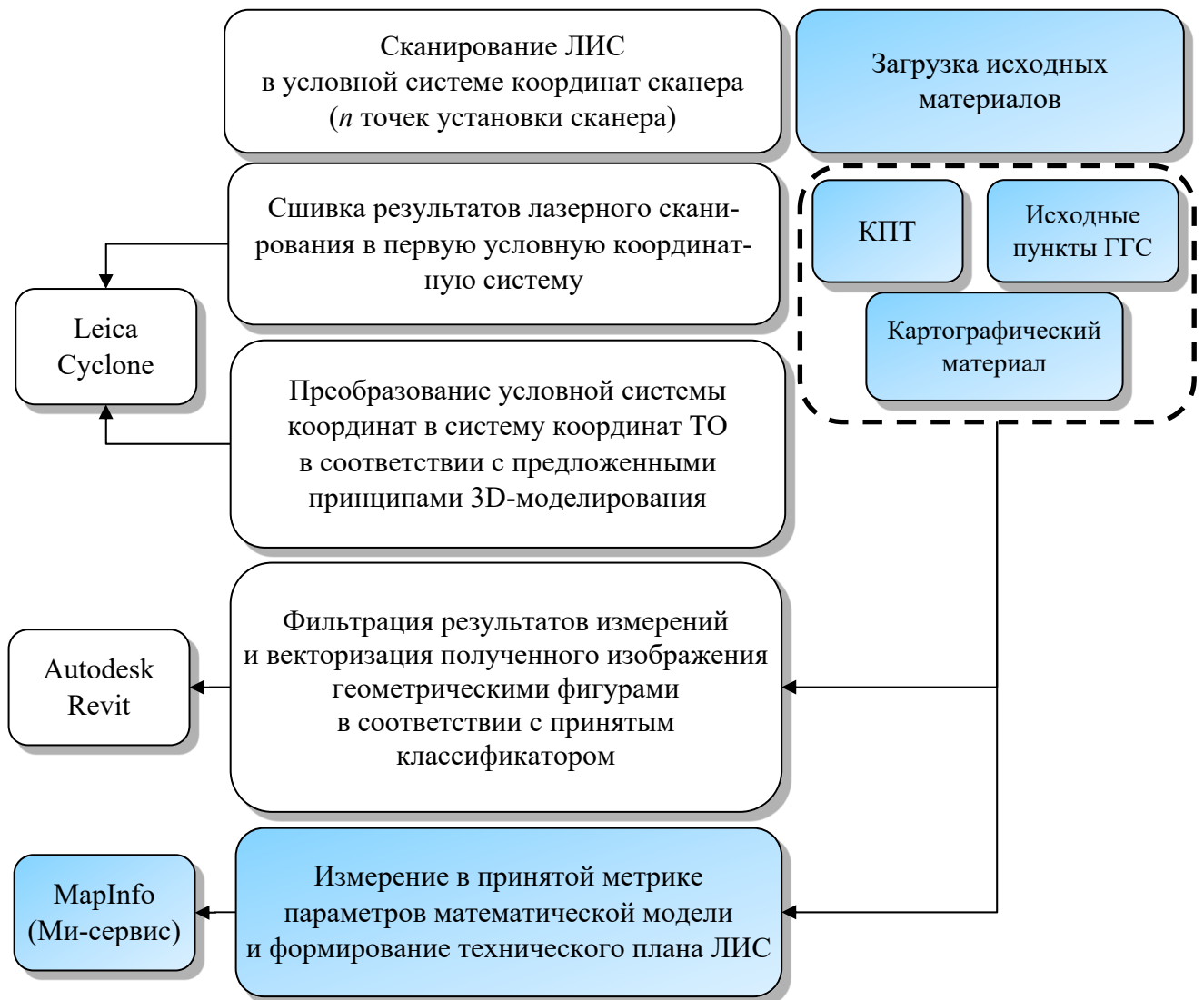
Рисунок 18 – Предлагаемый алгоритм формирования технического плана ЛИС
