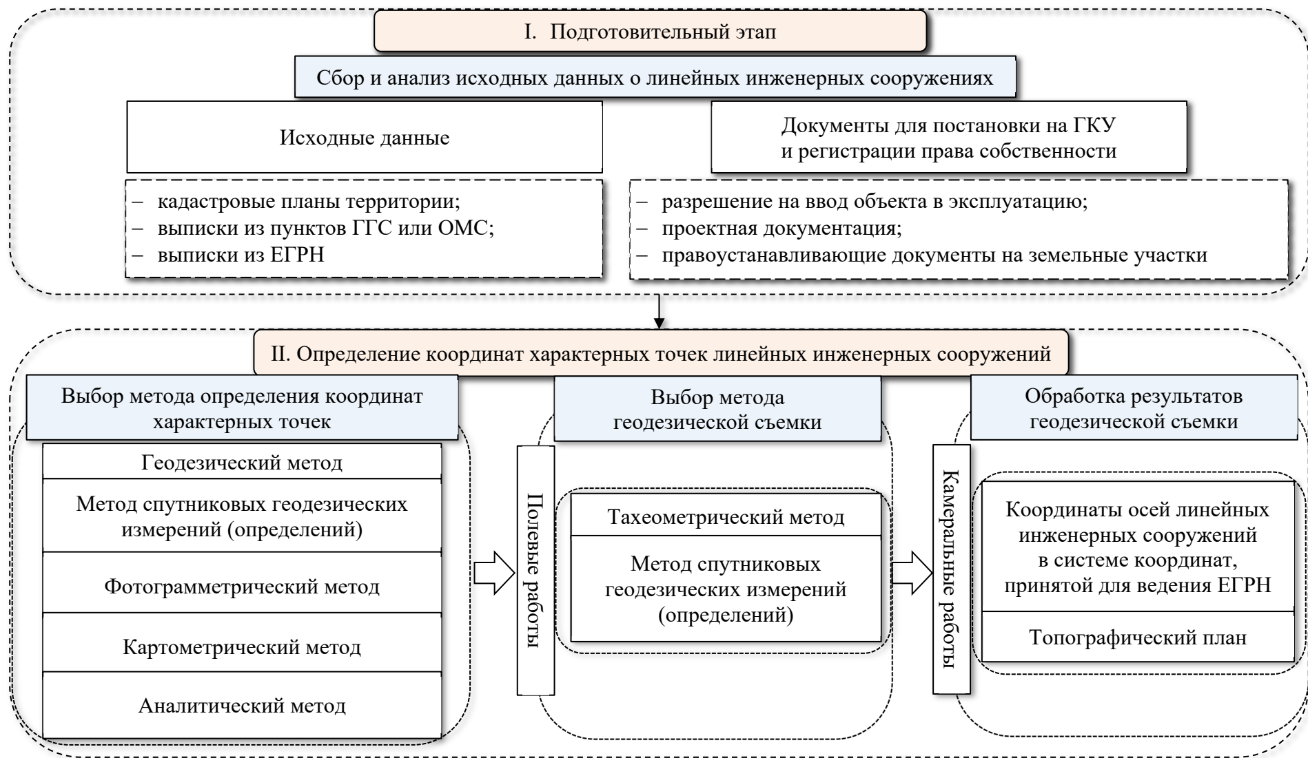
Рисунок 5 – Первый и второй этапы актуализированного алгоритма выполнения кадастровых работ в отношении линейных инженерных сооружений
