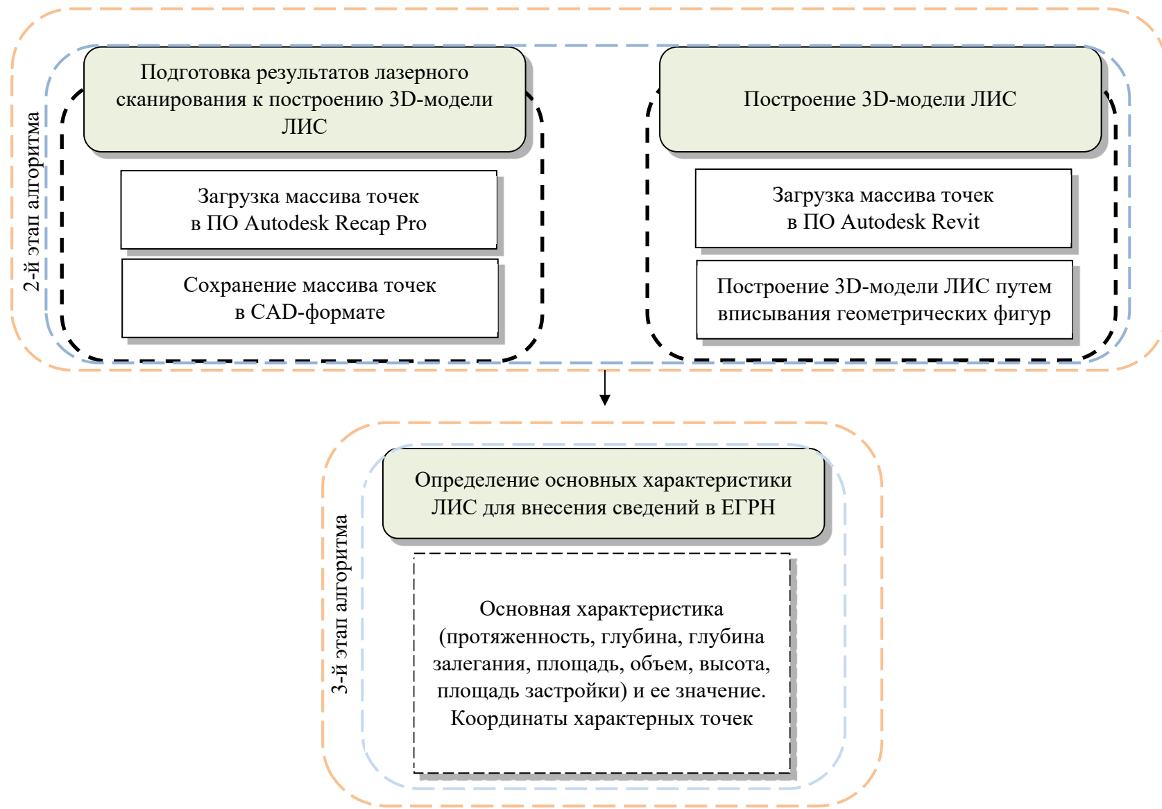
Рисунок 13 – Второй и третий этапы алгоритма формирования 3D-модели линейных инженерных сооружений
