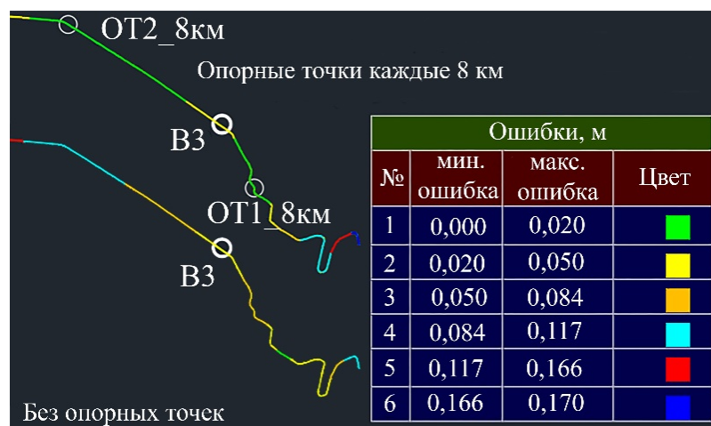
Рисунок 4.31 – Сравнение траектории, уравненной по размещенным каждые 8 км опорным точкам, с траекторией без уравнивания по опорным точкам
