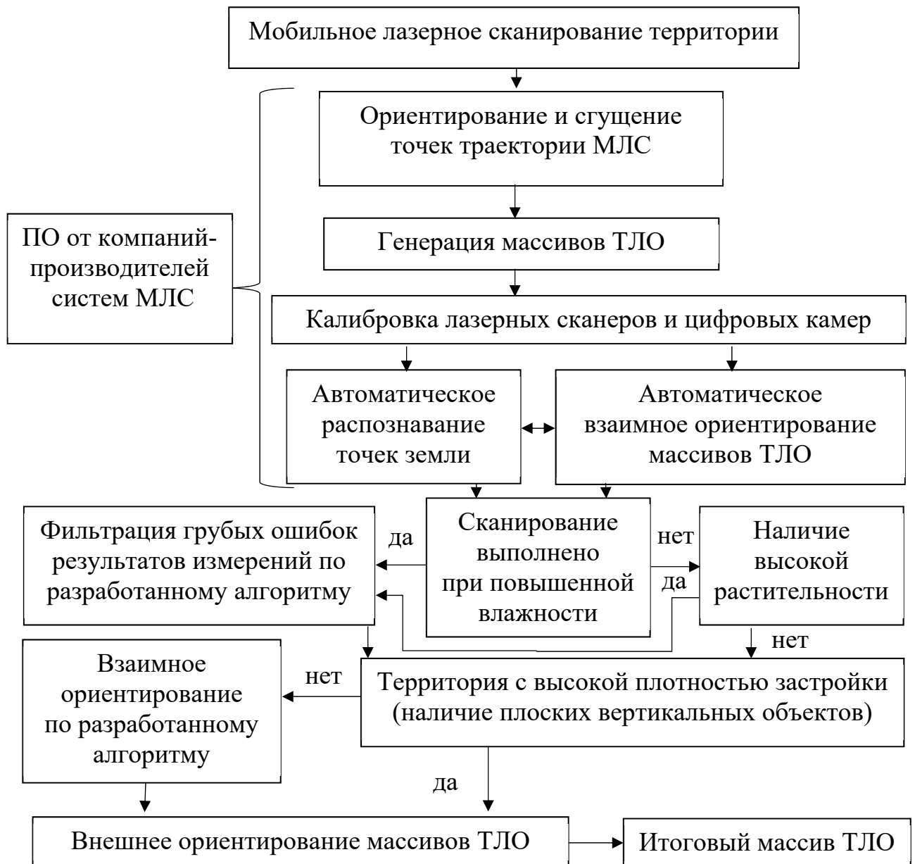
Рисунок 3.4 – Методика предварительной обработки данных МЛС
