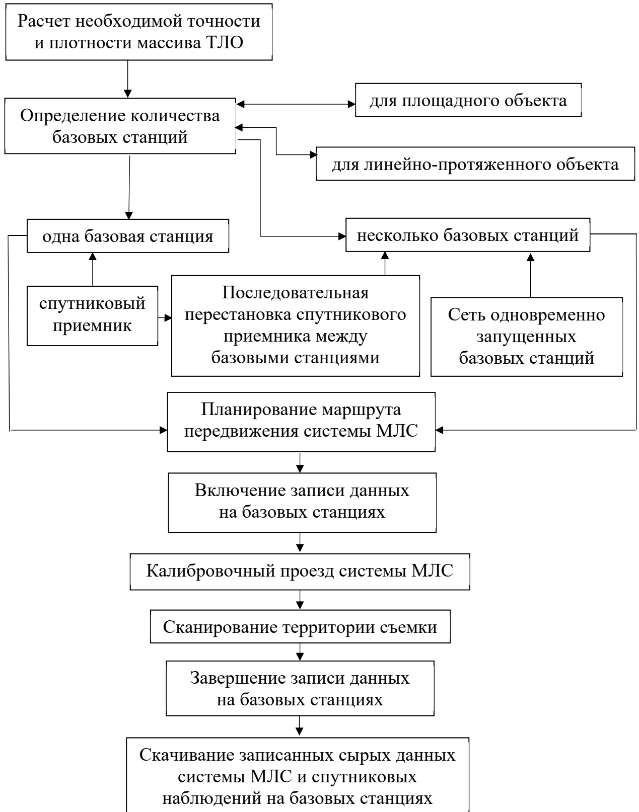
Рисунок 3.3 – Технологическая схема процесса МЛС
