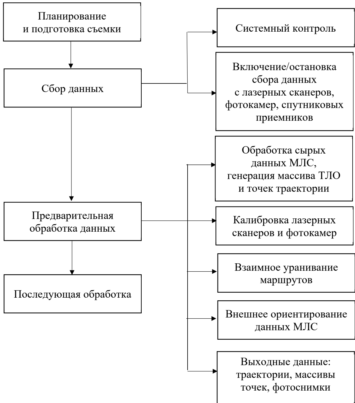
Рисунок 1.3 – Схема рабочего процесса МЛС
