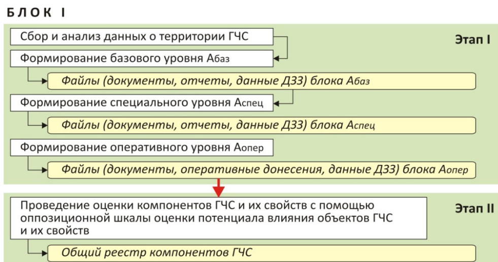
Рисунок 38 – Схема блока I технологической схемы создания и использования картографического обеспечения региональных органов управления в ЧС
