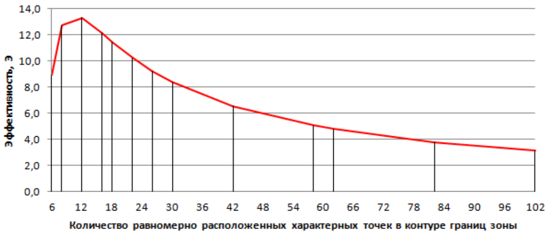
Рисунок 25 – Эффективность оценки точности определения площади от количества (равномерно расположенных в контуре границ зоны) характерных точек:
