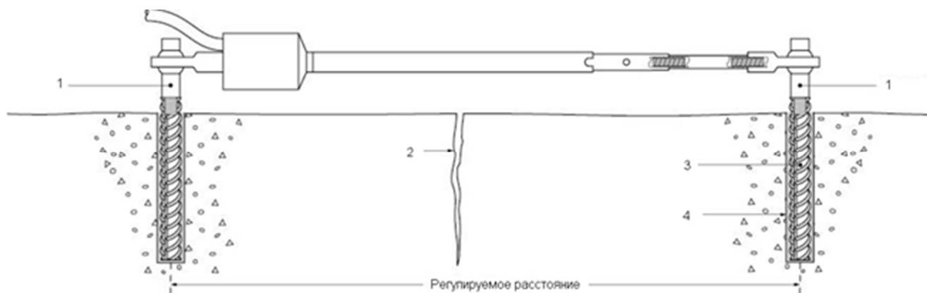
Рисунок 1.14 – Схема размещения датчика перемещений накладного типа (щелемера)
