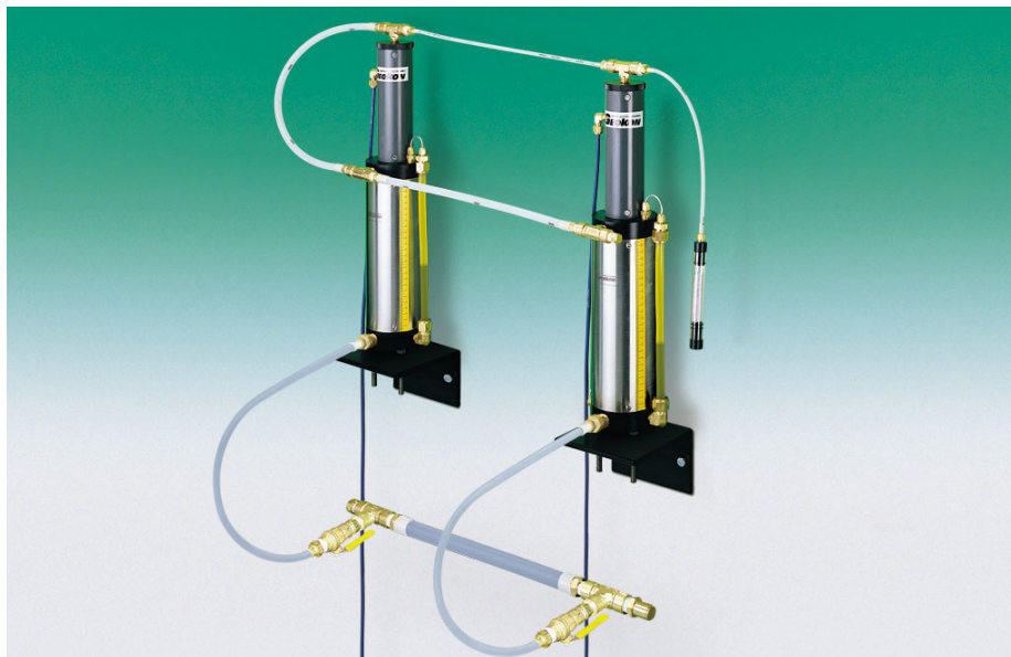
Рисунок 1.16 – Общий вид датчика гидростатического нивелирования
