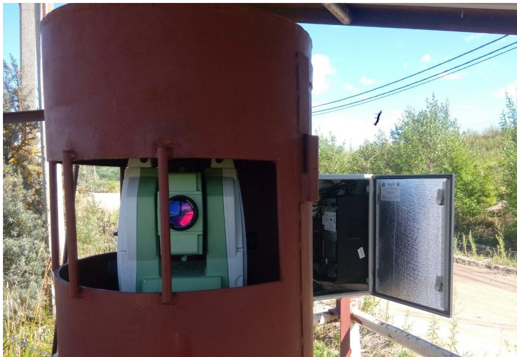
Рисунок 1.19 – Станция автоматизированного тахеометра системы геодезического мониторинга
