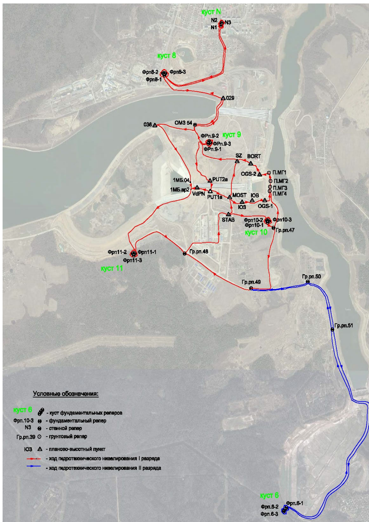
Рисунок 2.9 – Схема ходов нивелирования I и II классов Загорской ГАЭС-2
