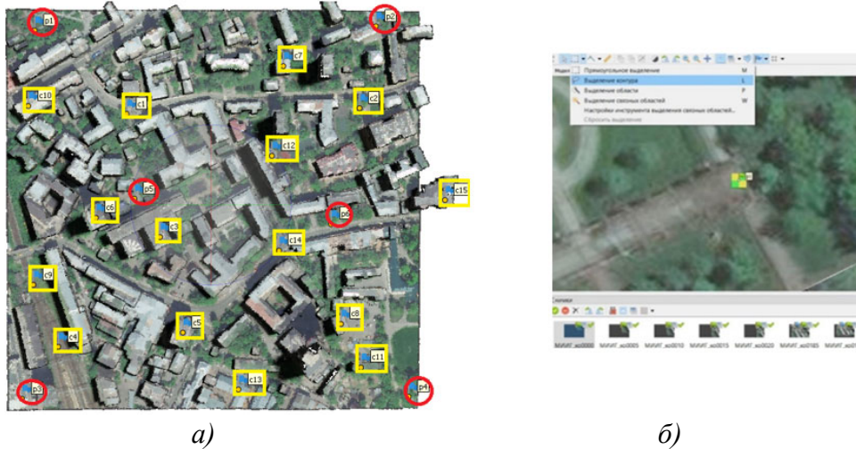
Рисунок Г.14 – Расположение опорных (в красном круге) и контрольных (в желтом квадрате) точек на территории съемки (а) и опорная точка на местности (б)
