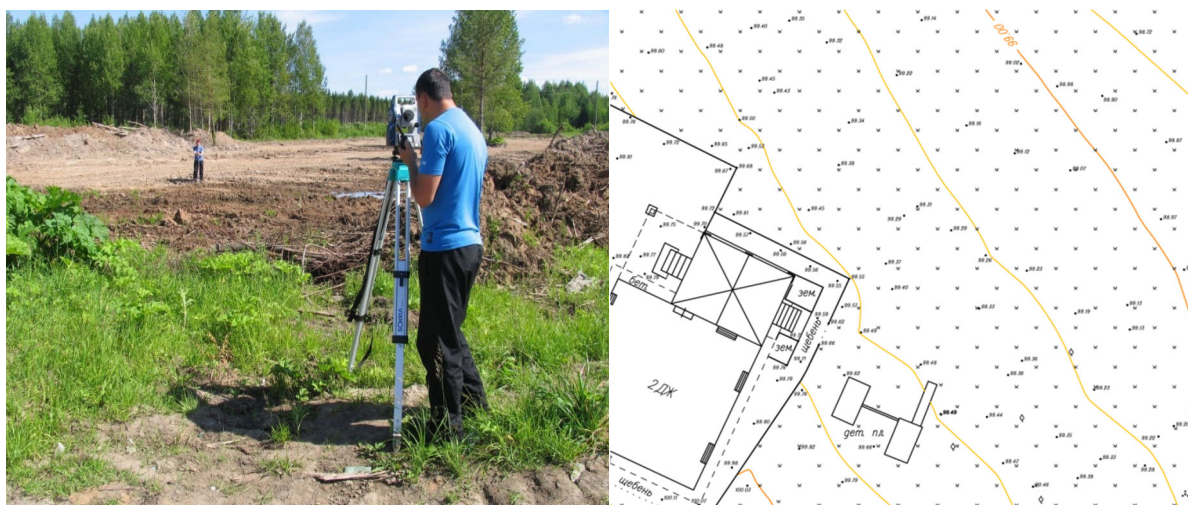
Рисунок 3 – Топогеодезическая съемка и результаты съемки рельефа в виде набора пикетов
