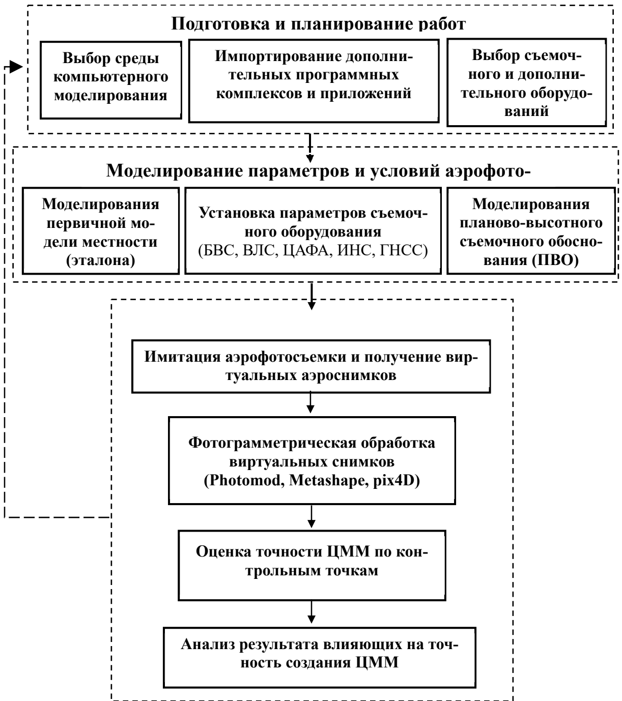
Рисунок Г.1. Обобщенная схема имитационного моделирования аэрофототопографической съемки для создания ЦММ
