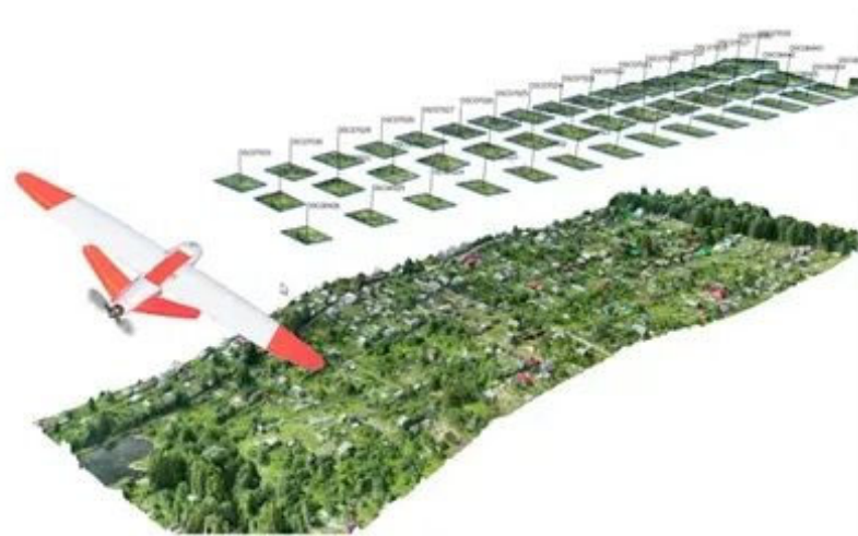
Рисунок 4 – Фотограмметрический метод создания ЦМР
