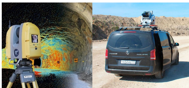
Рисунок 6 – Лазерно-локационные методы съемок (наземное и мобильное)
