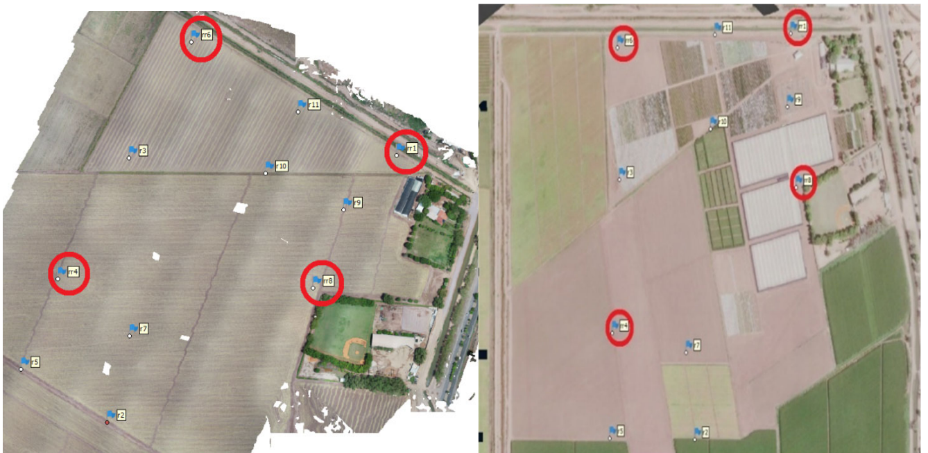
Рисунок 46 – Результат обработки данных аэрофототопографической съемки (слева реальная, справа имитационная)
