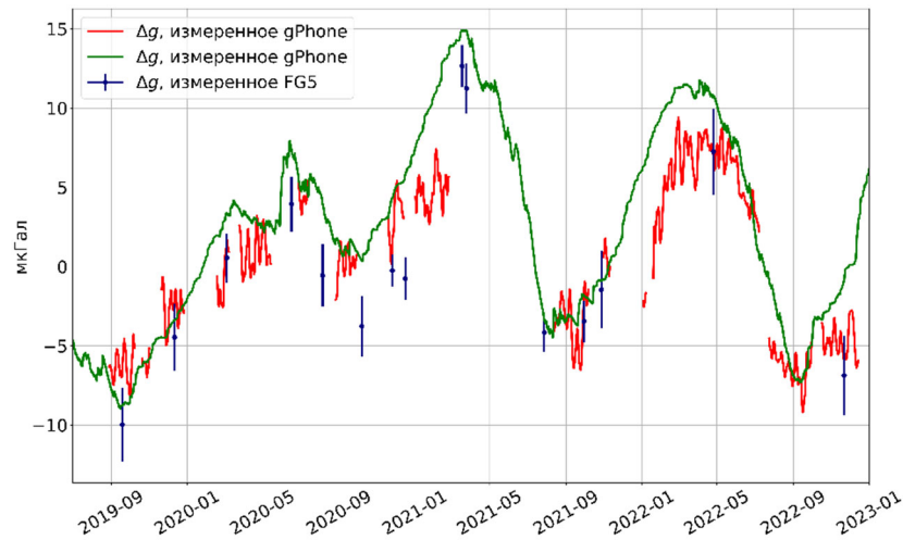
Рисунок 3.10 – График несприливных вариаций ускорения силы тяжести, полученных по результатам наблюдений гравиметрами и вычисленных по модели гидрологии
