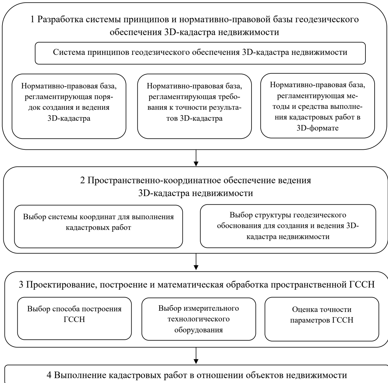
Рисунок 2 – Технологическая схема методики создания геодезического обеспечения трехмерного кадастра недвижимости
