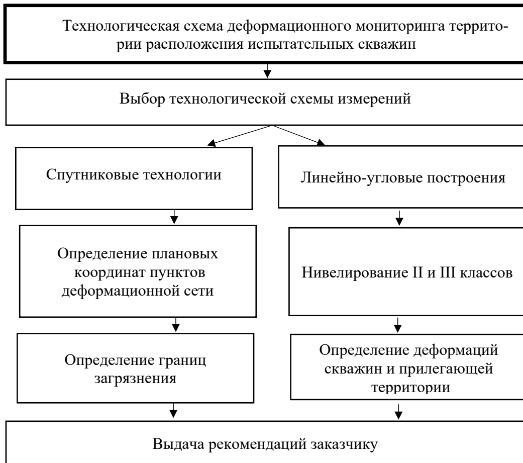
Рисунок 1 – Технологическая схема производства геодезических работ
