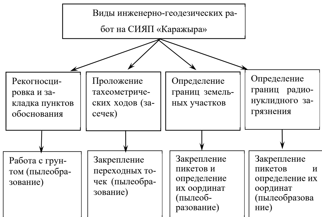
Рисунок 2.13 – Влияние загрязнения радионуклидами при выполнении геодезических работ
