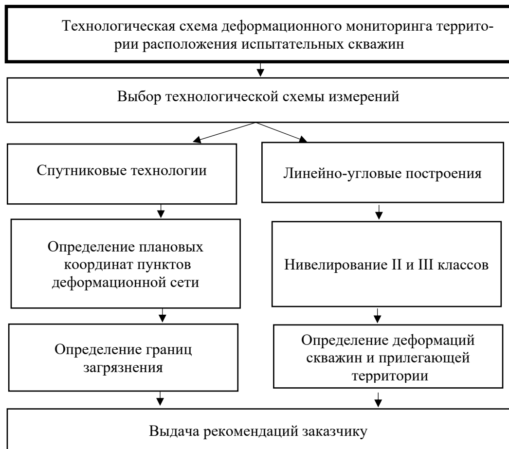
Рисунок 2.14 – Технологическая схема производства геодезических работ
