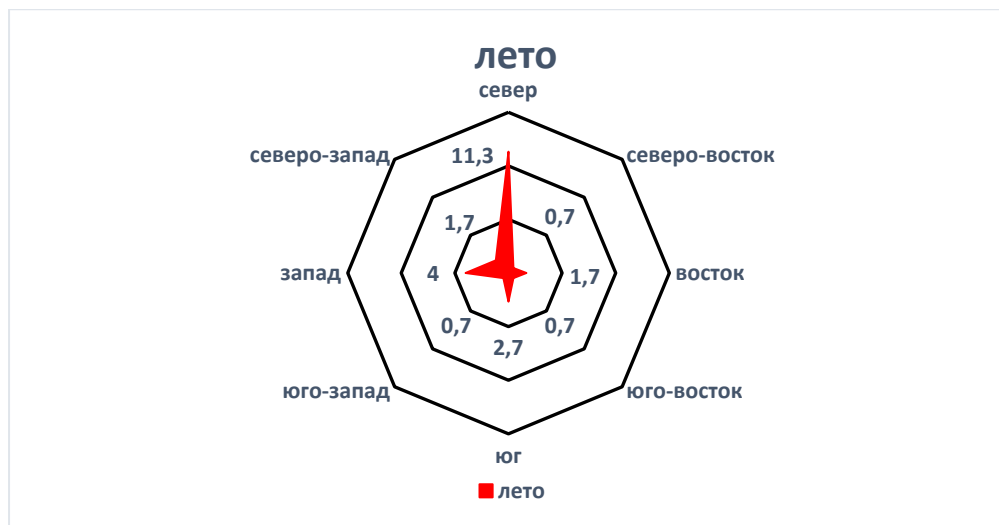
Рисунок 2.6 – Летняя роза ветров в районе испытательных скважин и угольного месторождения «Каражыра»
