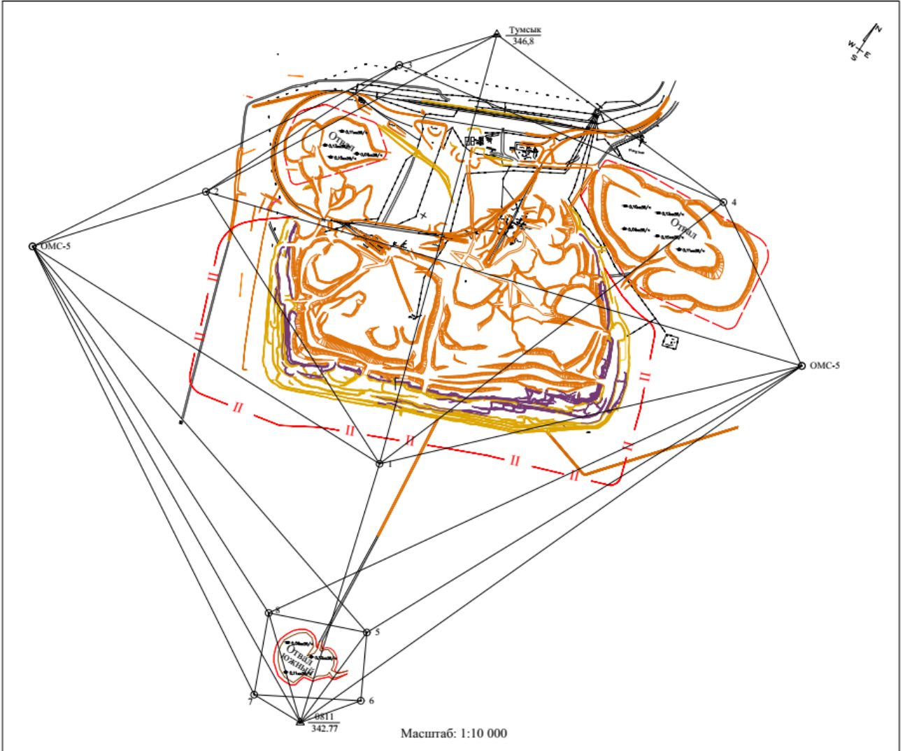
Рисунок 2.20 – Схема существующей сети на месторождении и отвалах вскрышных пород
