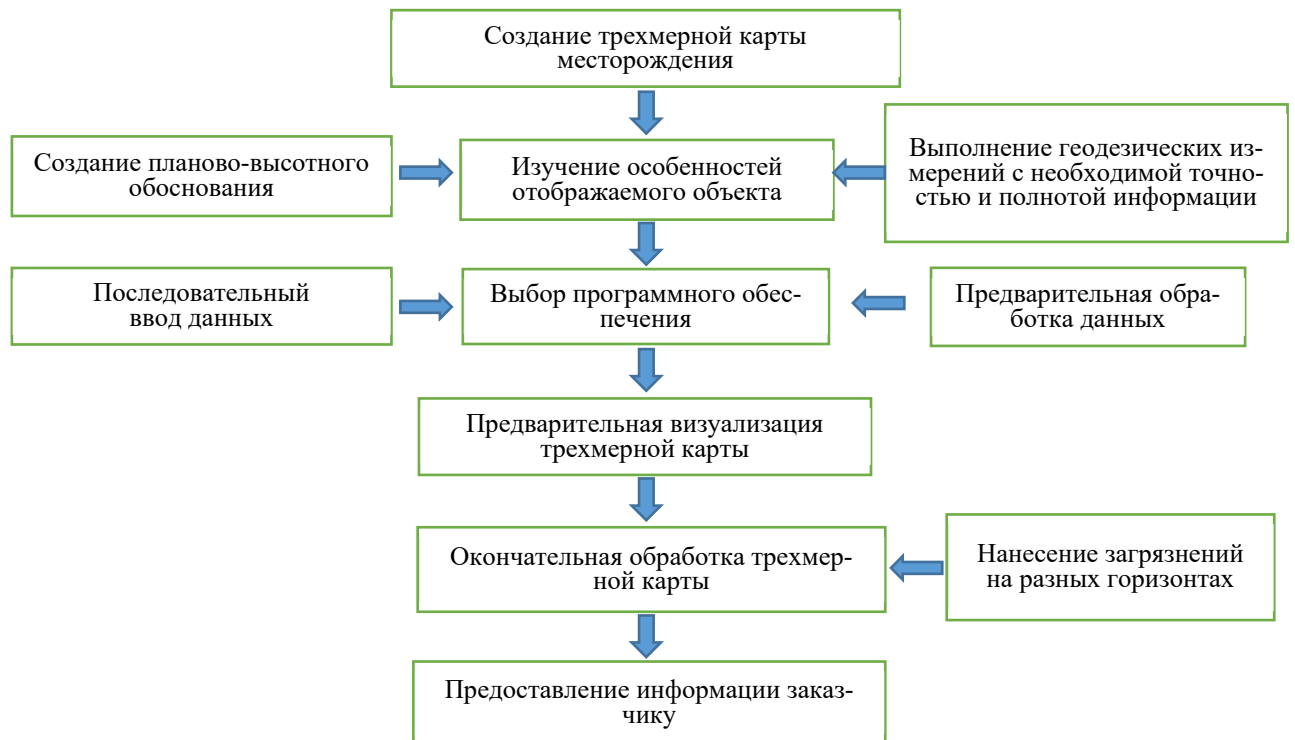
Рисунок 3.4 –Технологическая схема создания трехмерной карты угольного месторождения
