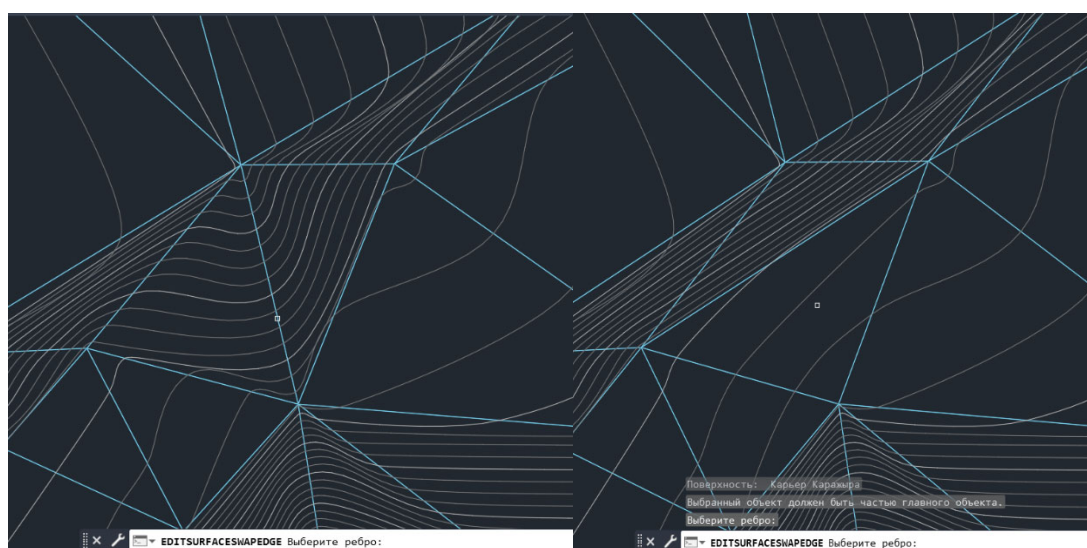
Рисунок 3.13 – Процесс редактирования поверхности путем перестановки ребер треугольников
