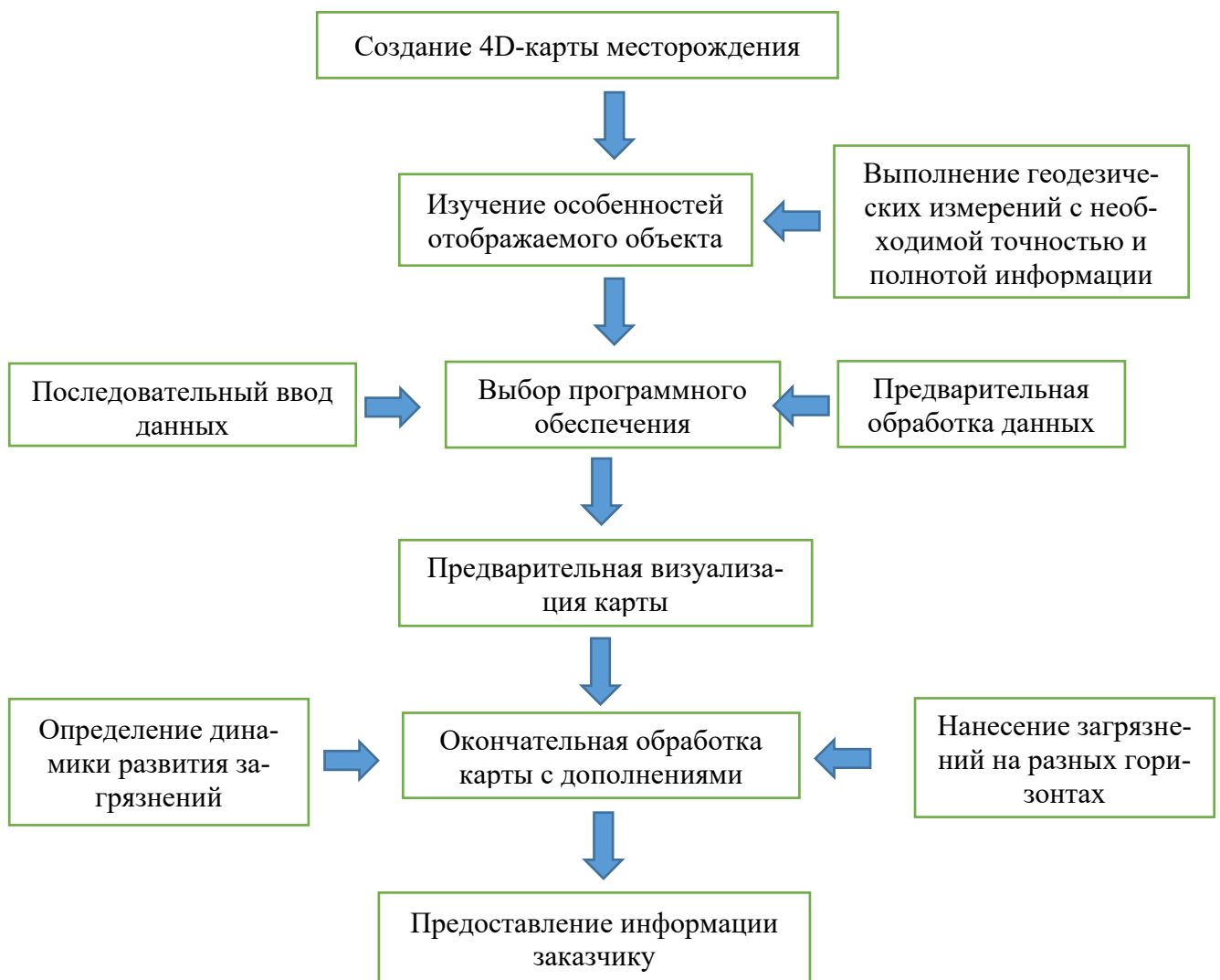
Рисунок 3.19 – Технологическая схема по созданию 4D-карты месторождения «Каражыра»
