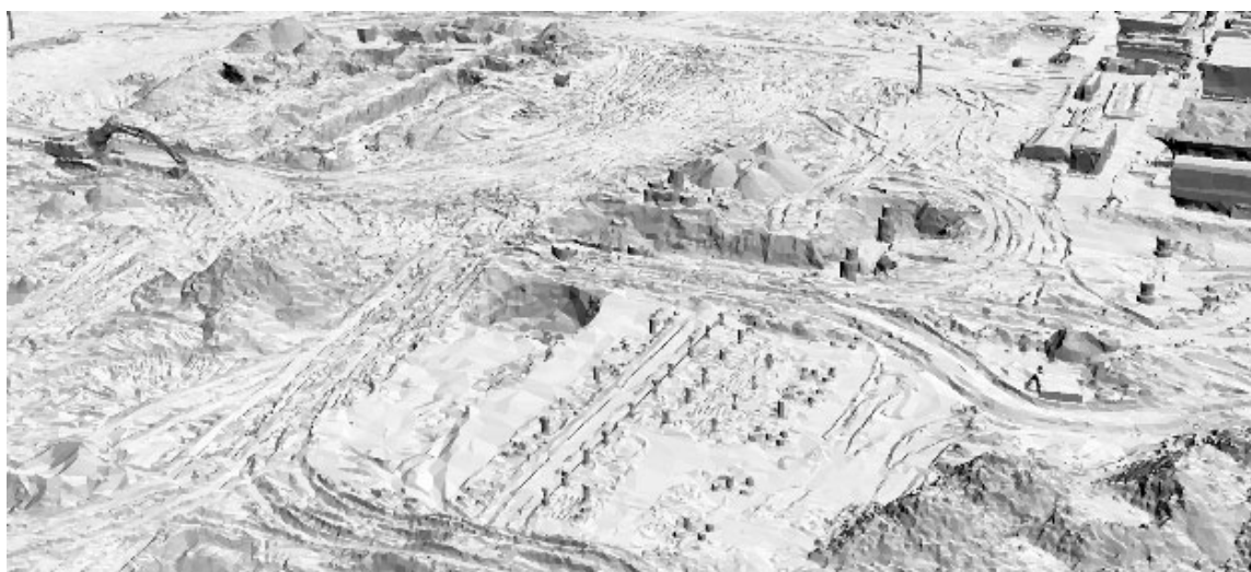
Рисунок 4.11 – Полигональная модель объекта строительства, построенная по результатам ЦАФС с БПЛА
