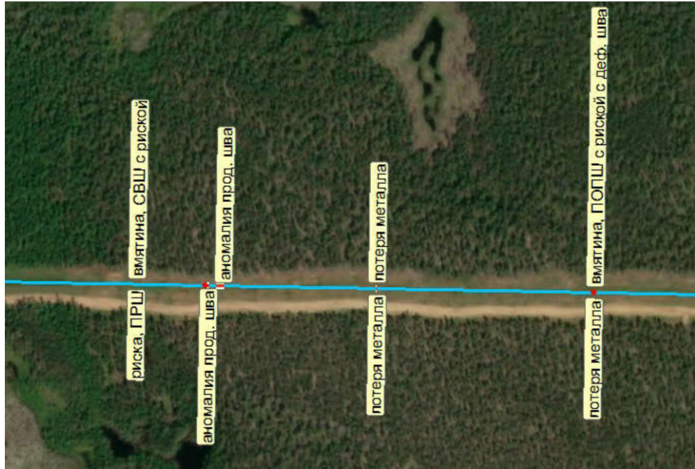
Рисунок 2.2 – Участок трубопровода с дефектами на космическом изображении (данные по дефектам получены по результатам внутритрубной диагностики, положение дефектов определено с использованием линейной системы координат)
