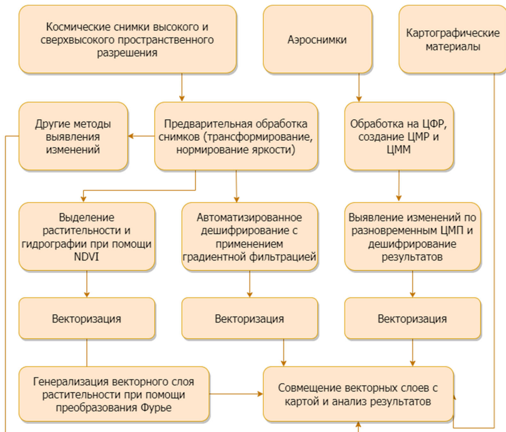
Рисунок 1.11 – Технологическая схема комплексного мониторинга застроенных территорий по данным аэрокосмической съемки
