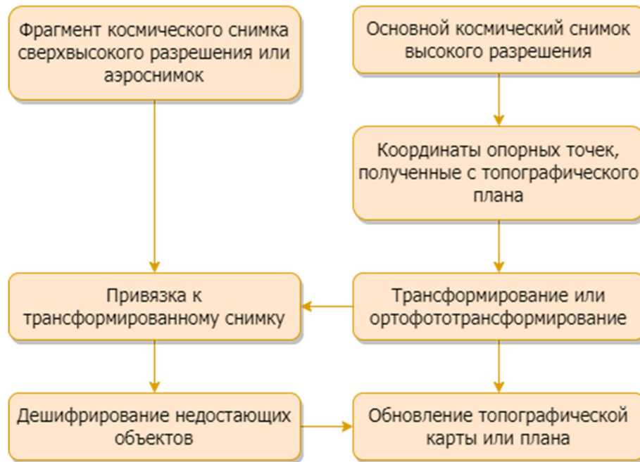
Рисунок 1.13 – Технологическая схема обновления цифровой топографической продукции по аэрокосмическим изображениям видимого диапазона
