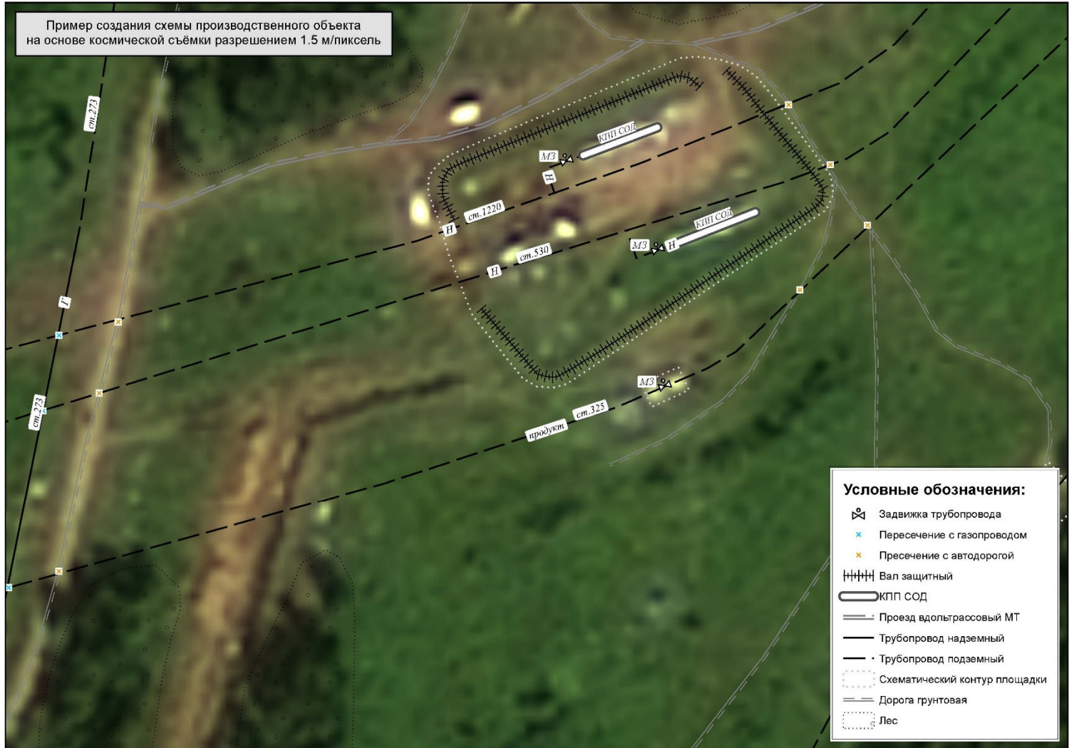
Рисунок 4.3 – Схема дешифрирования участка ЛЧ МН на космическом изображении с разрешением 1,5 м/пикс
