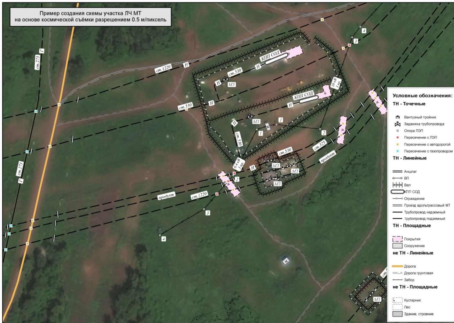
Рисунок 4.4 – Схема дешифрирования участка ЛЧ МН на космическом изображении с разрешением 0,5 м/пикс
