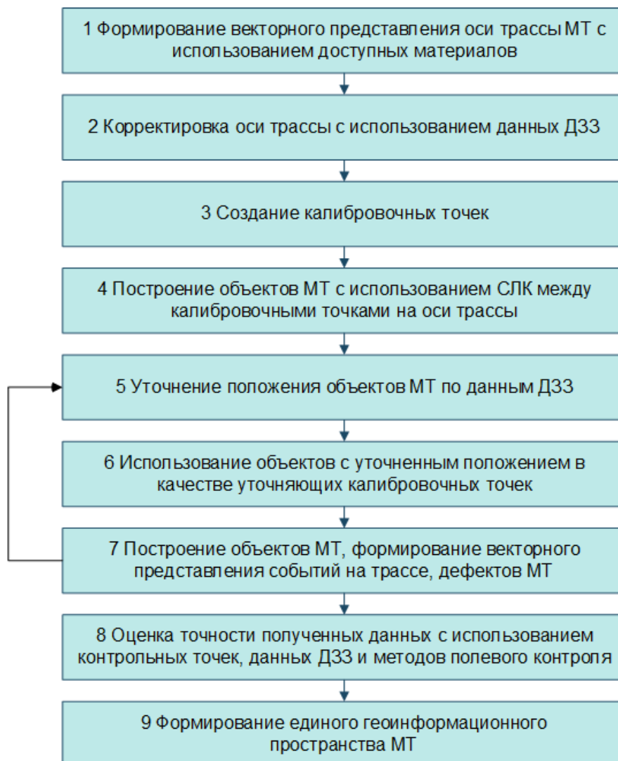
Рисунок 3.10 – Технология формирования единого геоинформационного пространства с использованием СЛК и данных ДЗЗ
