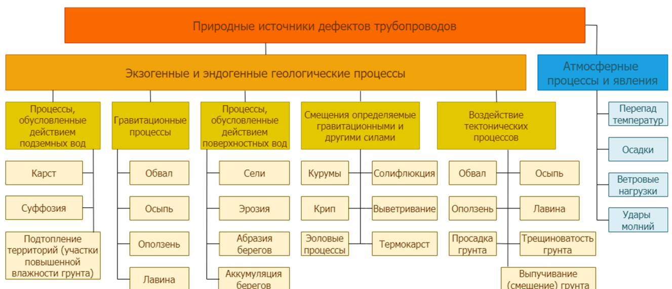
Рисунок 3.13 – Природные источники возникновения дефектов и аварийных ситуаций на магистральных нефтепроводах
