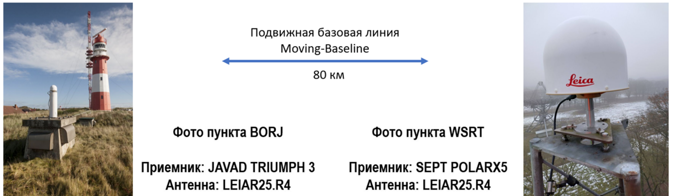
Рисунок 22 – Пункты, используемые в псевдокинематических испытаниях с подвижной базовой линией
