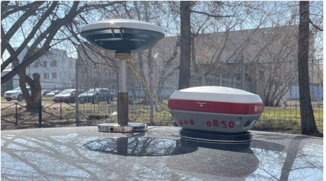
Рисунок 20 – Экспериментальная установка на крыше автомобиля (слева – антенна «Мобильной станции»; справа – приемник Stonex S800A для построения эталонного трека)
