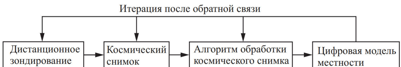
Рисунок 2.2 – Схематическое изображение интерпретации данных ДЗЗ и получения цифровой модели местности с обратной связью
