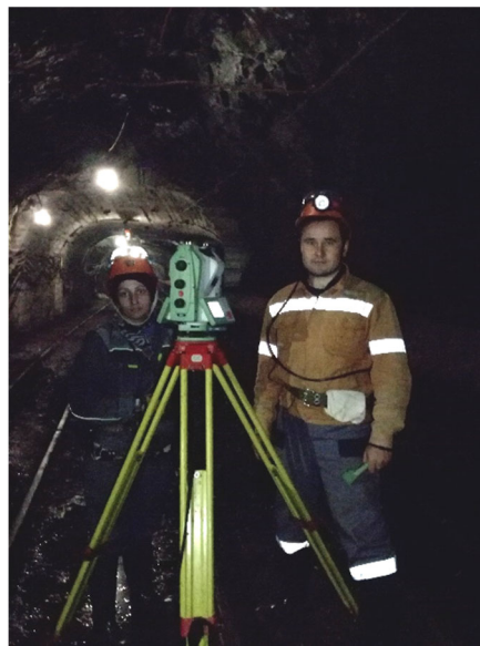
Рисунок 2.29 – Наблюдения по реперам на откаточном штреке гор. + 44 м
