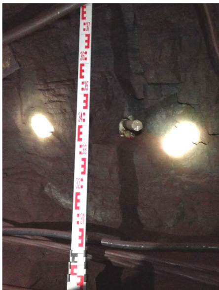
Рисунок 2.29 – Наблюдения по реперам на откаточном штреке гор. + 44 м
