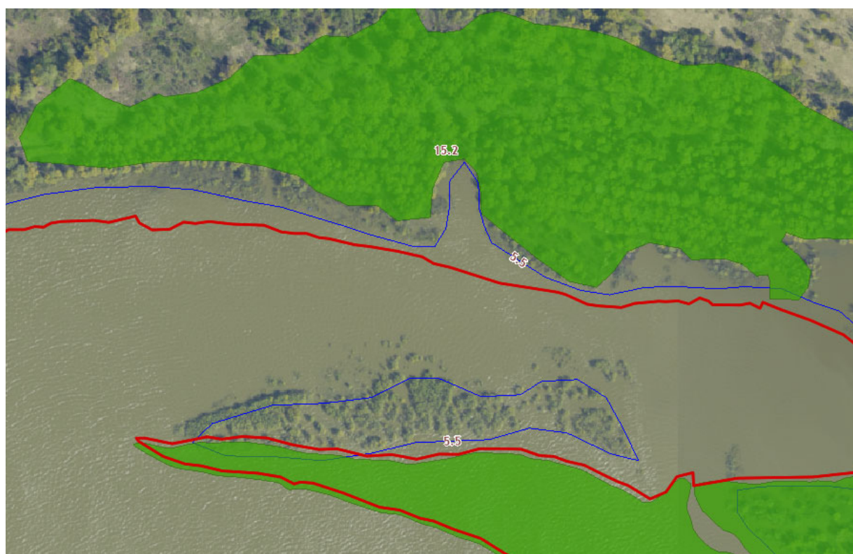
Рисунок 26 – Граница береговой линии реки Обь не совпадает с границей зоны затопления с реестровым номером 54:00-6.42
