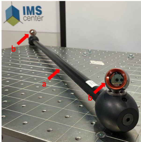
Рисунок 3.6 – Масштабный жезл (а), сферические отражатели (b)
