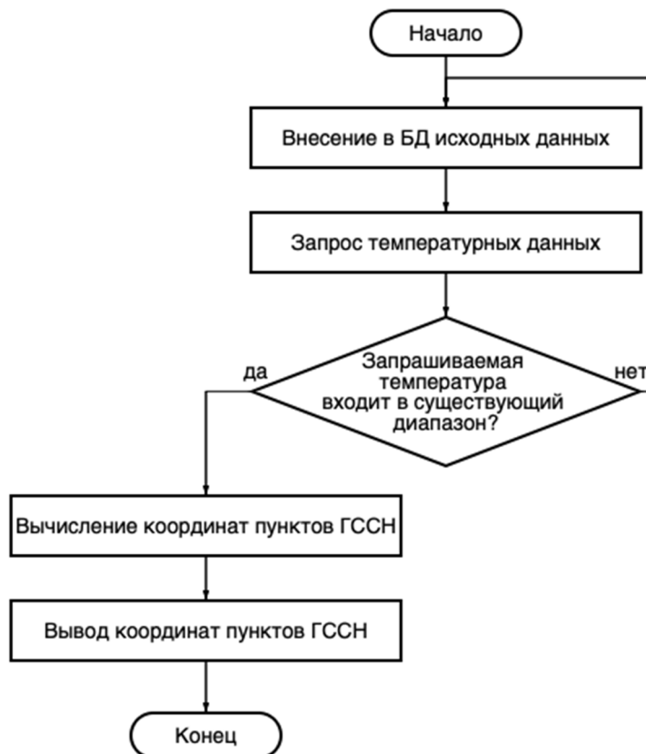
Рисунок 3.32 – Блок-схема алгоритма учета температурных деформаций
