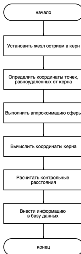
Рисунок 4.13 – Блок схема алгоритма определения координат керна с использованием жезла скрытых точек
