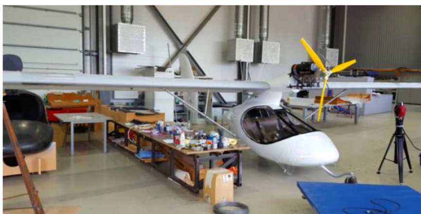
Рисунок 1.26 – Применение КОС для контроля внешних обводов готового изделия
