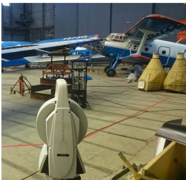
Рисунок 1.3 – Процесс сборки летательного аппарата и контроля его геометрических параметров
