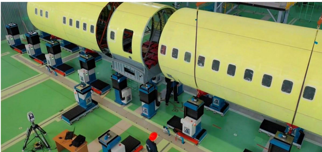
Рисунок 1.24 – Стыковка и сборка фюзеляжа самолета ИЛ-114-300
