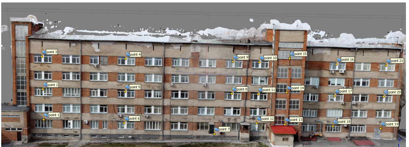
Рисунок 2.18 – Расположение опорных и контрольных точек
