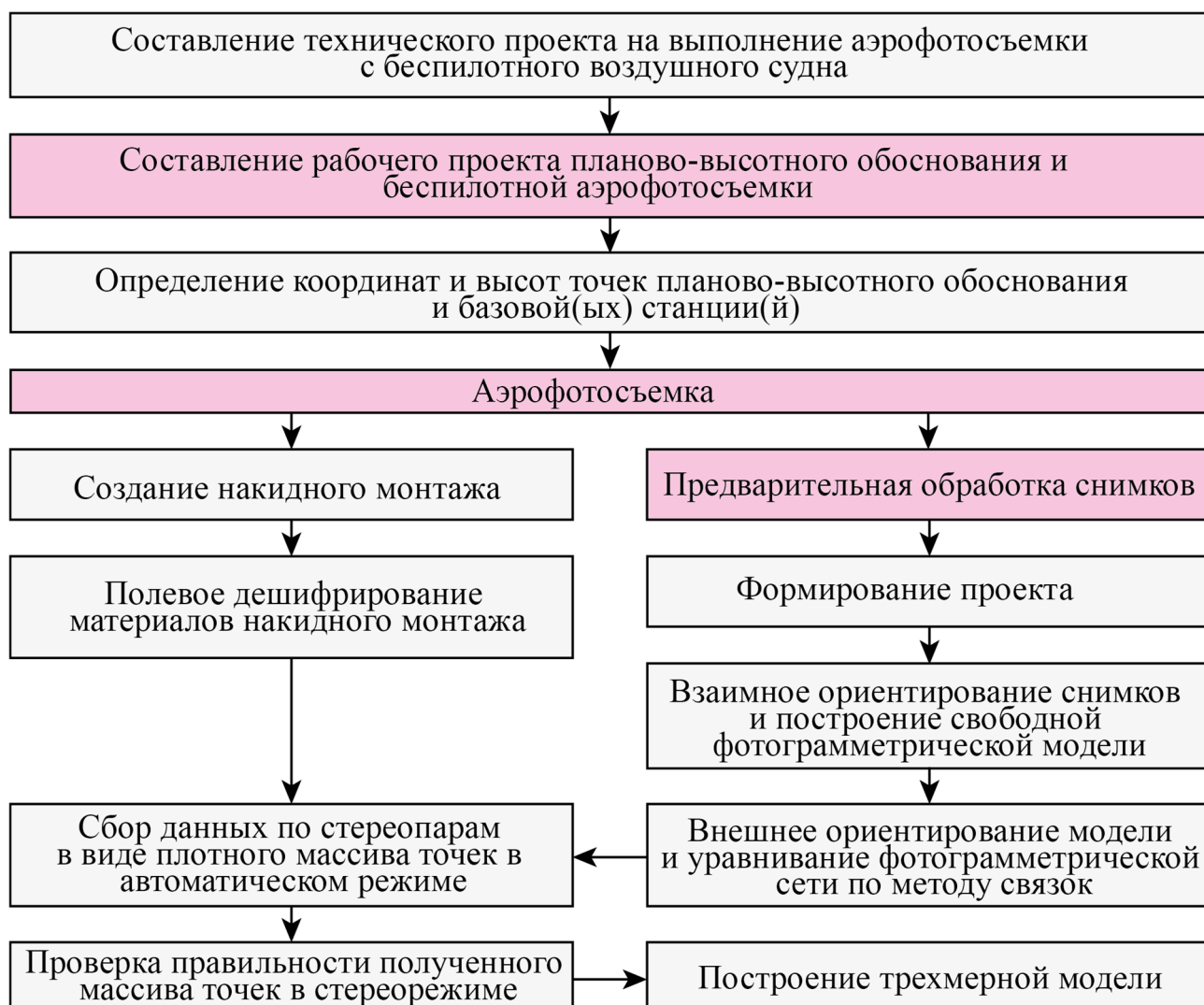
Рисунок 3 – Схема усовершенствованной методики обработки материалов аэрофотосъемки с беспилотных воздушных судов для трехмерного моделирования территорий
