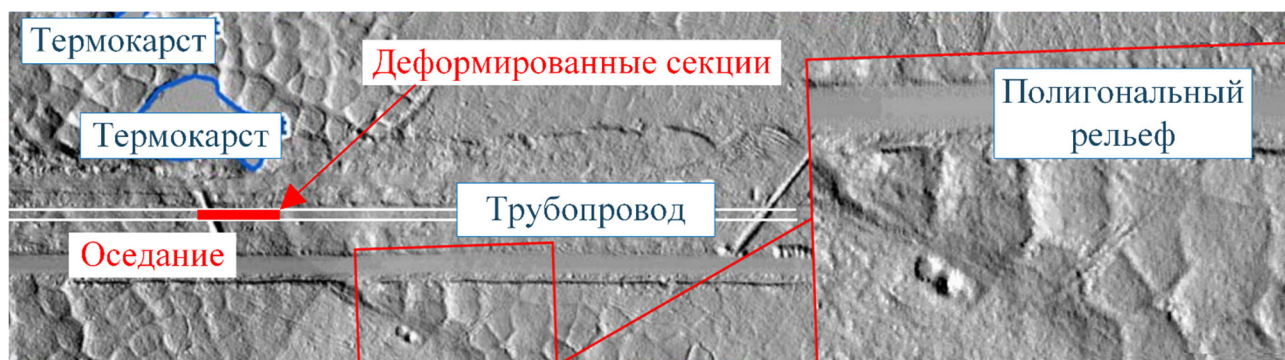
Рисунок 10 – Реализация технологии аэрокосмического мониторинга при анализе ЦМР и данных ВТД на участке МТ
