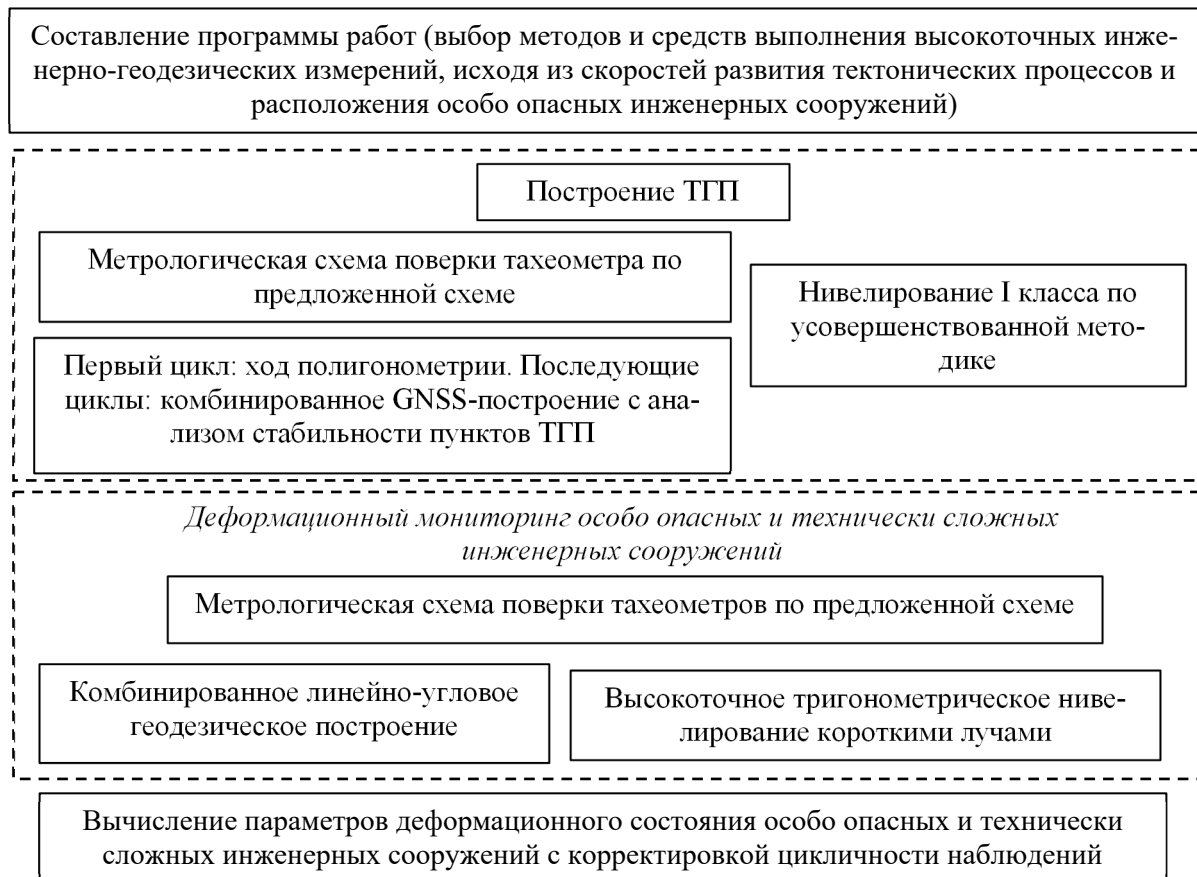
Рисунок 2 – Предлагаемая технологическая схема выполнения инженерно-геодезических работ на техногенных геодинамических полигонах АЭС
