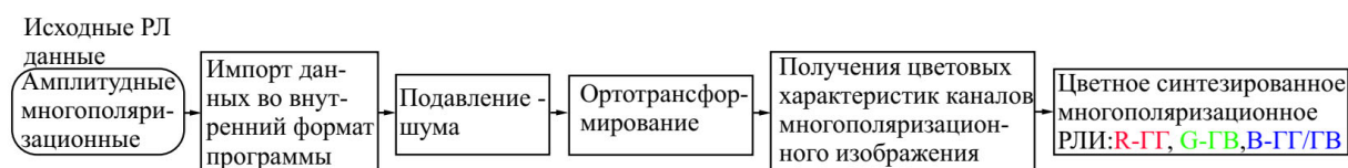
Рисунок 4 – Схема формирования псевдоцветного амплитудного РЛ изображения
