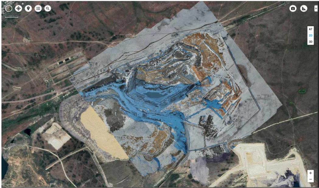
Рисунок 2.27 – Ортофотоплан исследуемого участка с пространственным разрешением 4,69 см/пиксель
