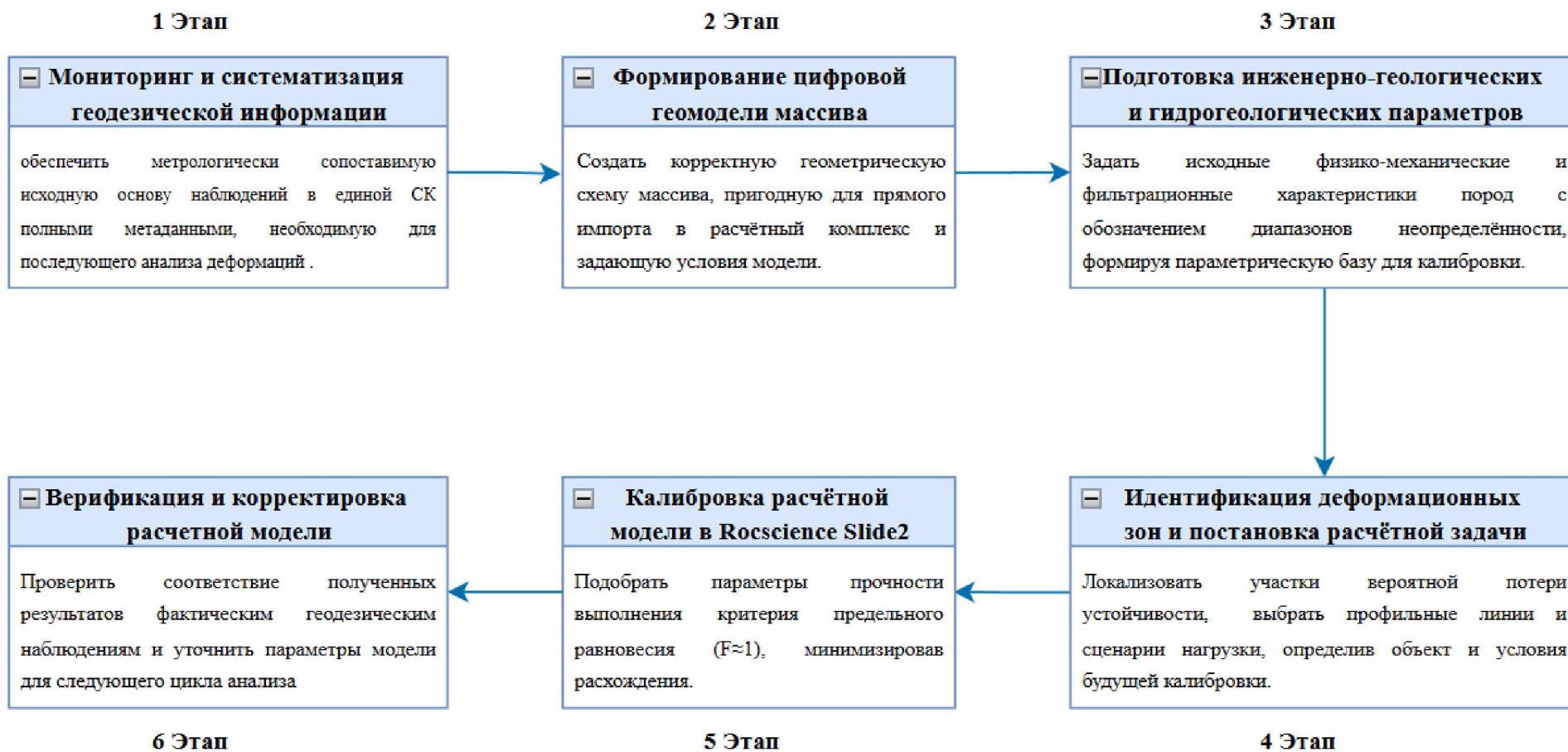
Рисунок 3.3 – Структурная схема метода Back Analysis
