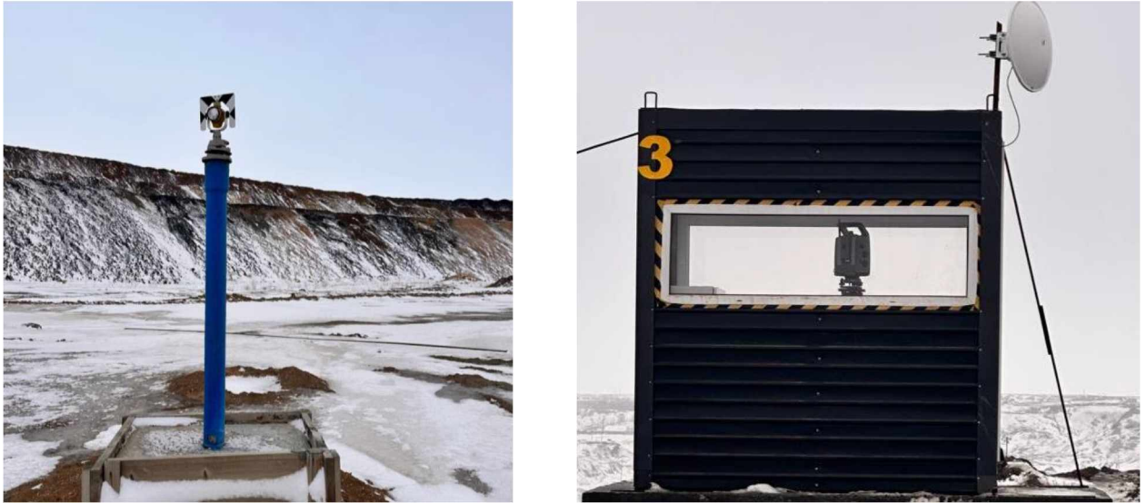
Рисунок 1.6 – Система GeoMoS на карьерах Жайремского ГОКа
