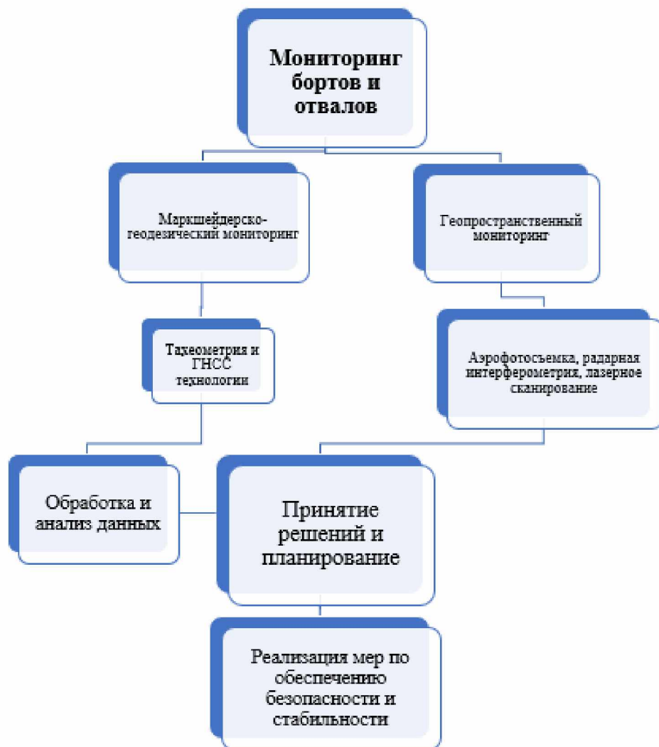
Рисунок 1.15 – Структурная схема методов мониторинга бортов карьеров и отвалов
