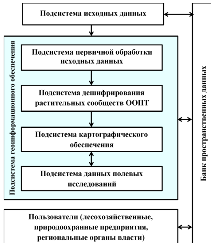
Рисунок 1 – Принципиальная технологическая схема автоматизированного дешифрирования растительных сообществ ООПТ с использованием геоинформационных технологий
