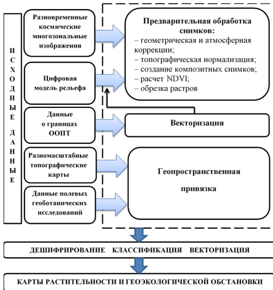
Рисунок 2 – Технологическая схема обработки многозональных космических изображений
