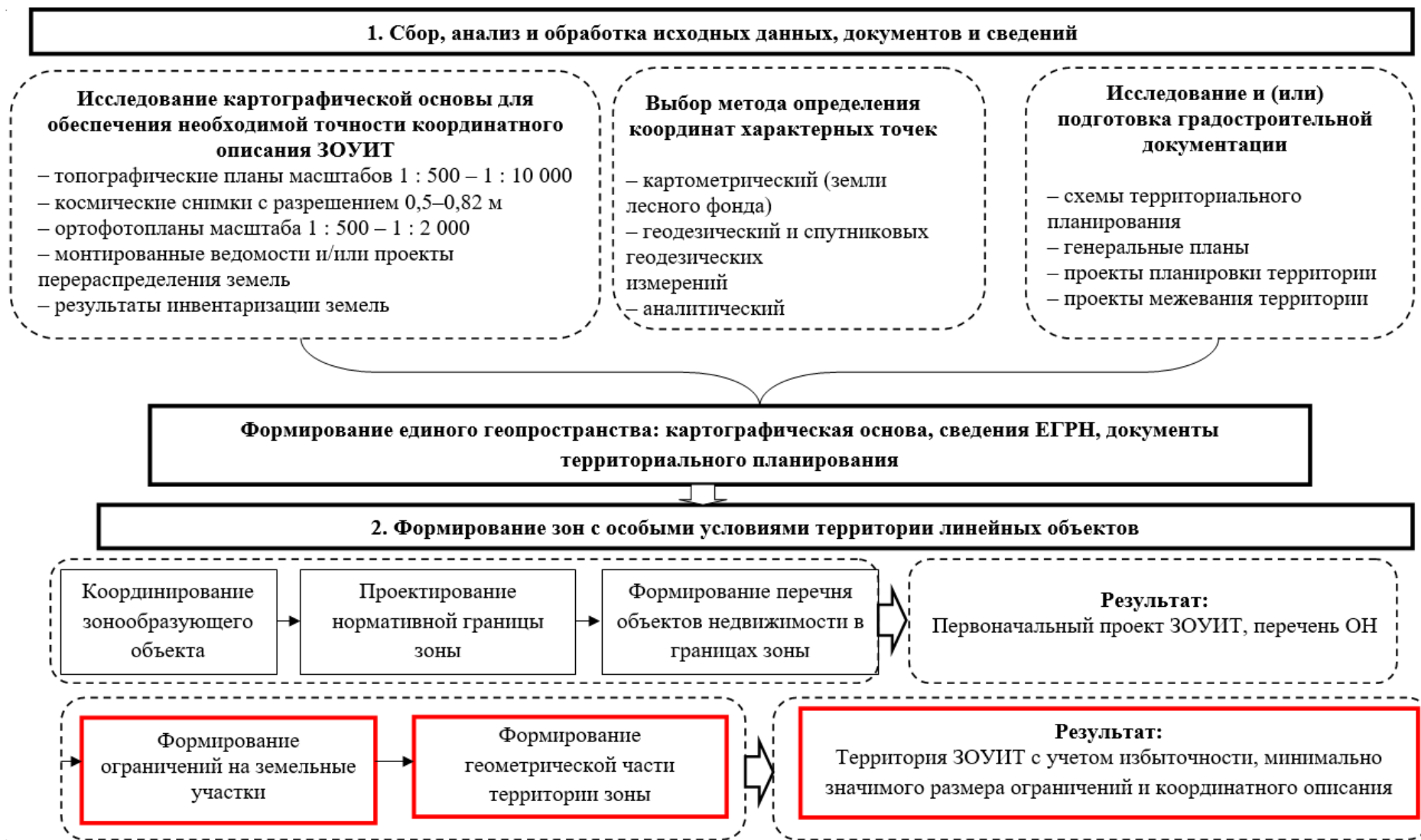
Рисунок 4 – Блок-схема усовершенствованной методики по выполнению работ по установлению границ ЗОУИТ линейных объектов (часть 1)
