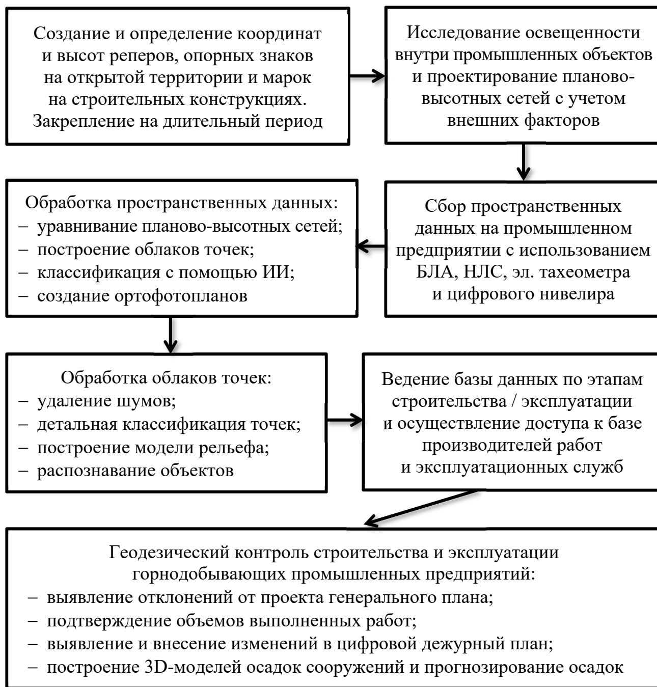
Рисунок 3 – Схема геодезических работ на промышленном объекте для выполнения геодезического мониторинга
