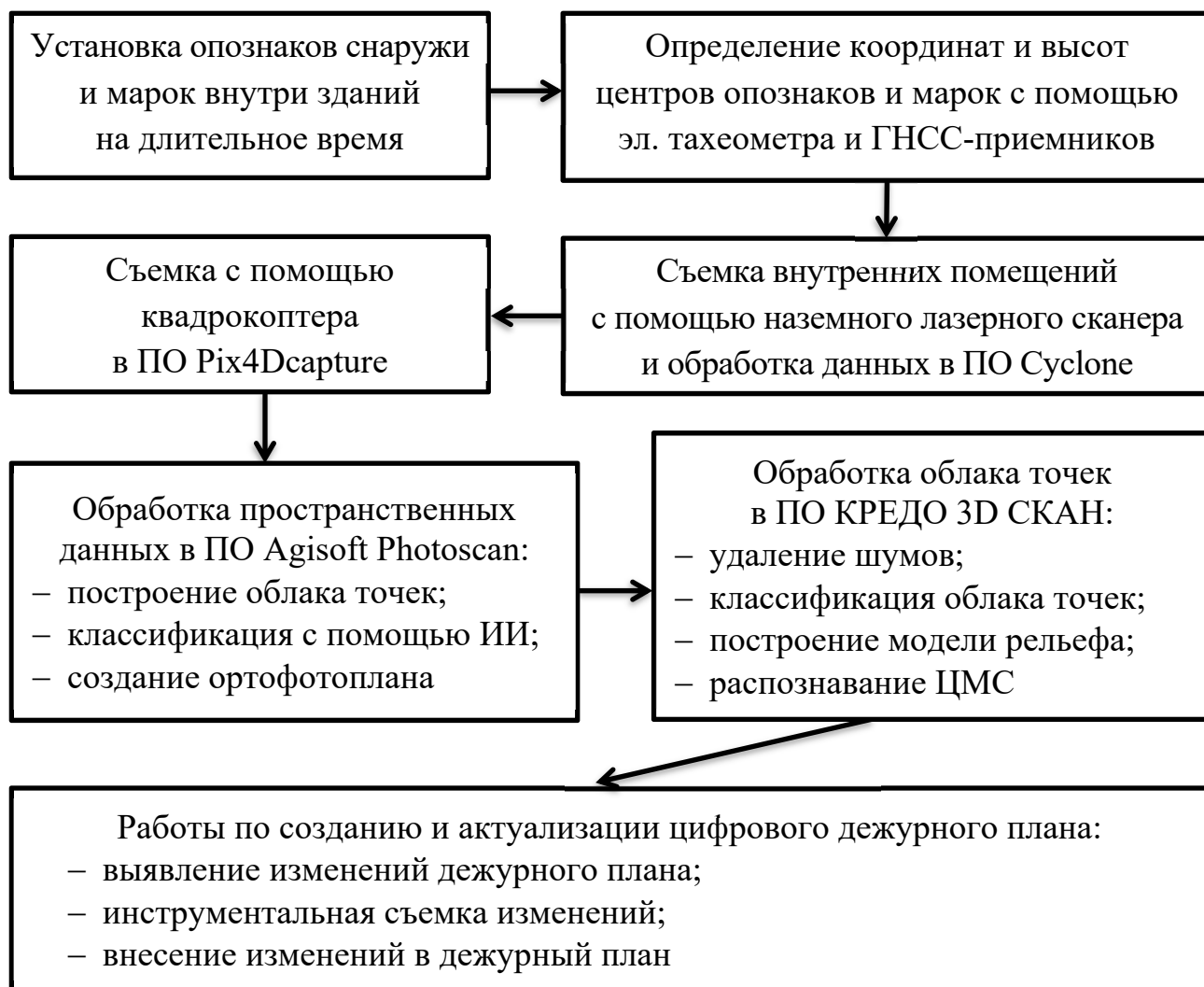
Рисунок 2 – Технологическая схема геодезических работ на объекте для ведения цифрового дежурного плана
