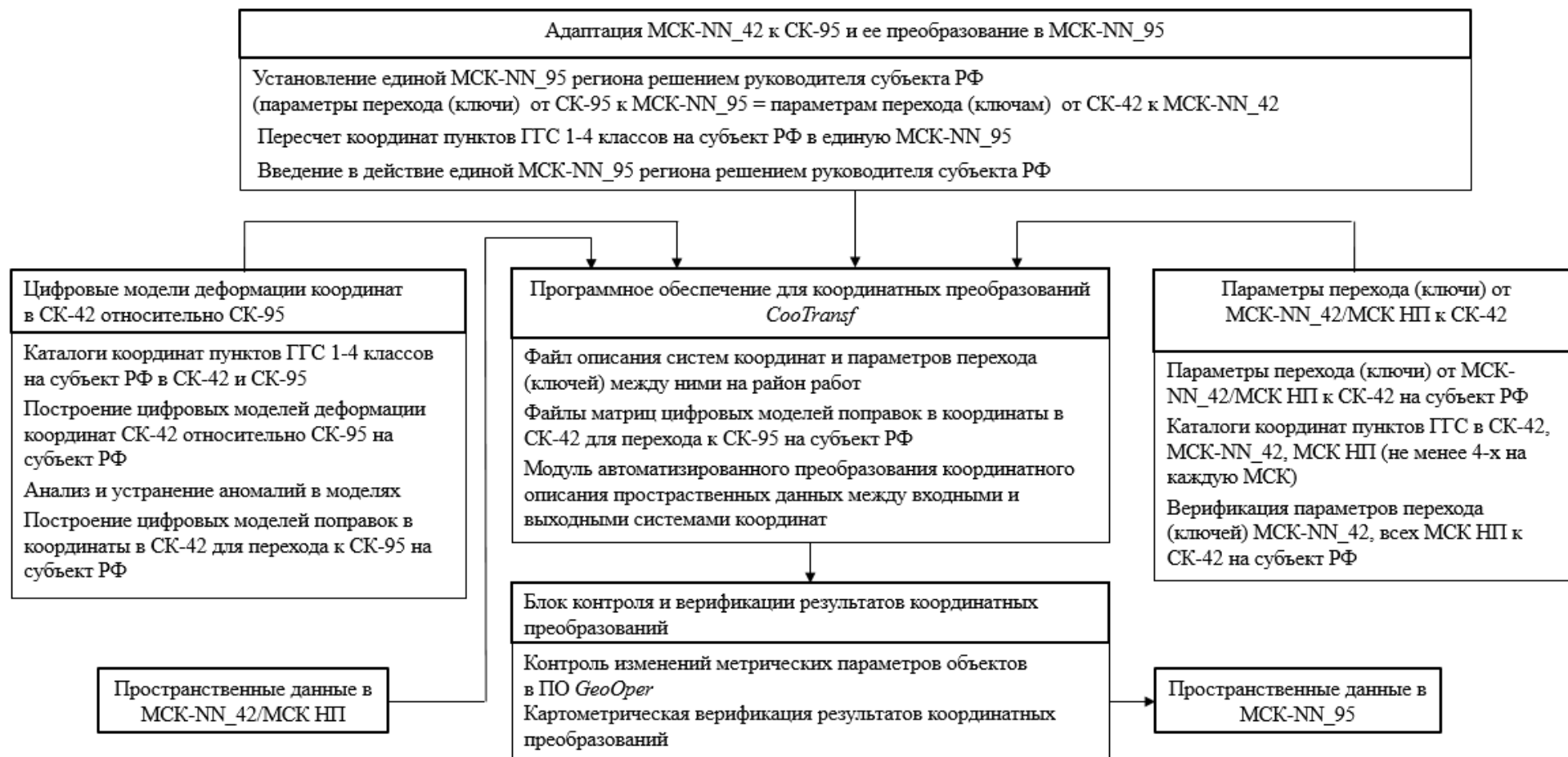
Рисунок 12 – Технологическая схема создания единого высокоточного координатного пространства субъекта РФ на этапе «Перехода типа I» от СК-42 к СК-95
