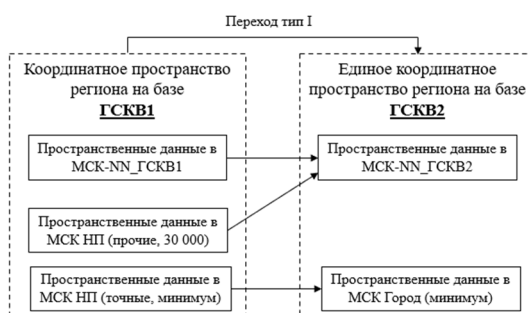
Рисунок 10 – Технологическая схема адаптации МСК-NN ГСКВ1 к ГСК вида 2
