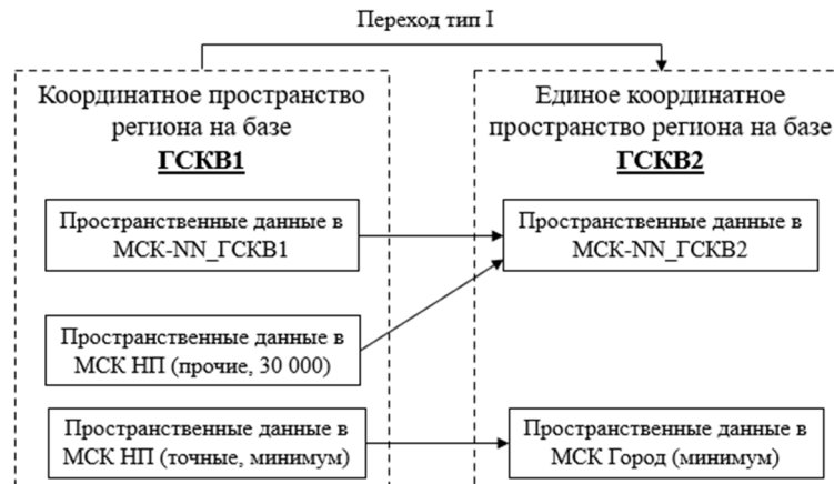
Рисунок 2.11 – Технологическая схема адаптации МСК-NN_ГСКВ1 к ГСК вида 2
