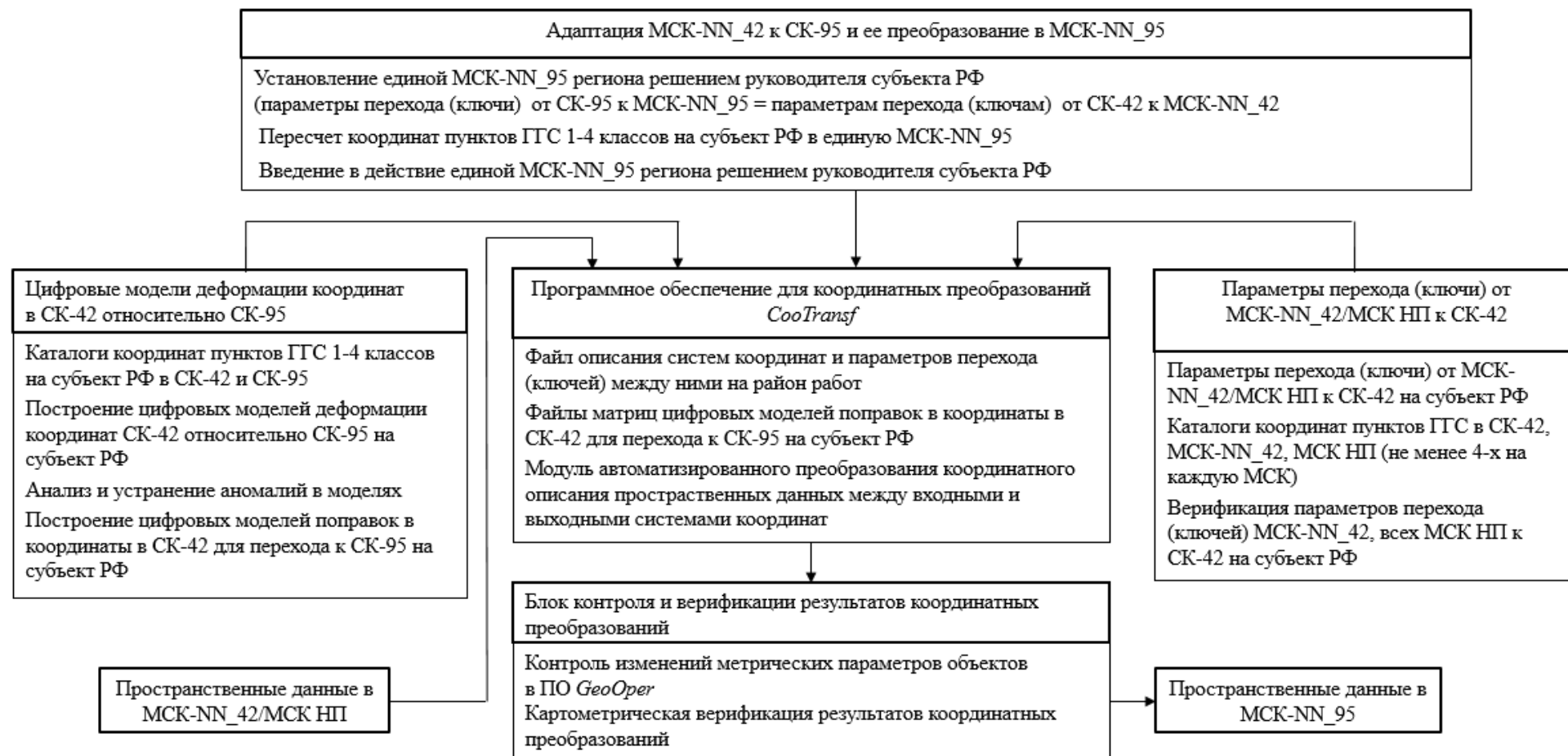
Рисунок 3.1 – Технологическая схема создания единого высокоточного координатного пространства субъекта РФ на этапе «Перехода типа I» от СК-42 к СК-95
