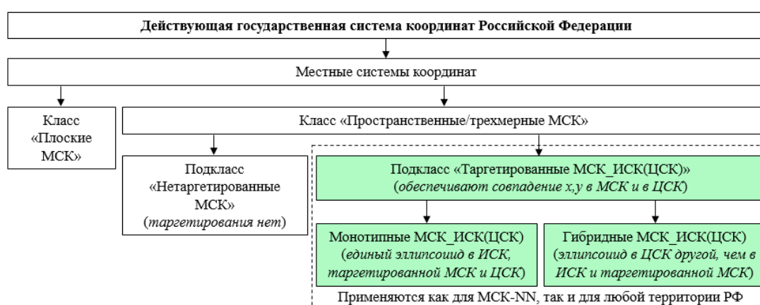
Рисунок 2.4 – Место вновь разработанного подкласса таргетированных местных систем координат вида МСК_ИСК(ЦСК) в классе пространственных МСК
