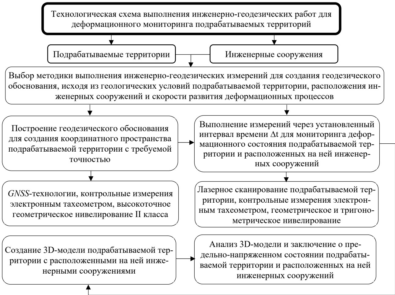
Рисунок 1 – Предлагаемая технологическая схема инженерно-геодезических работ при деформационном мониторинге обрабатываемых территорий и расположенных на них инженерных сооружений
