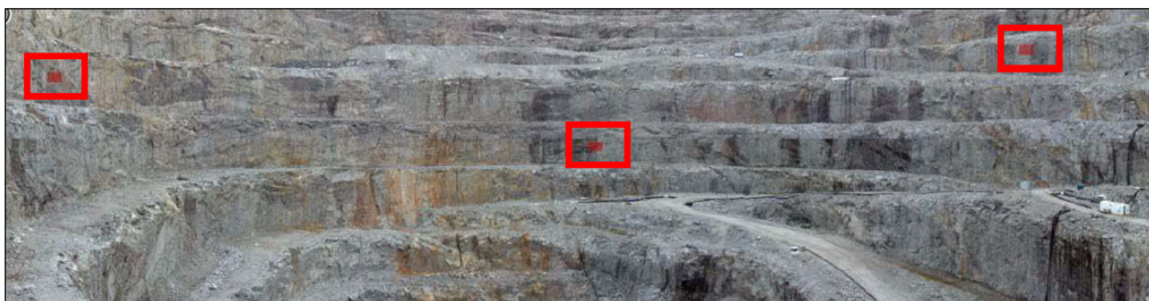
Рисунок 44 – Пример мест размещения уголковых отражателей и условных зон устойчивости.
