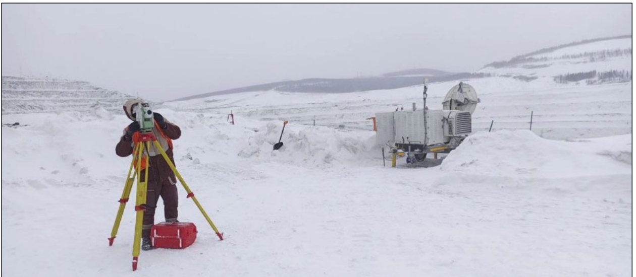
Рисунок 30 – Привязка радара Reutech MSR300 в карьере
