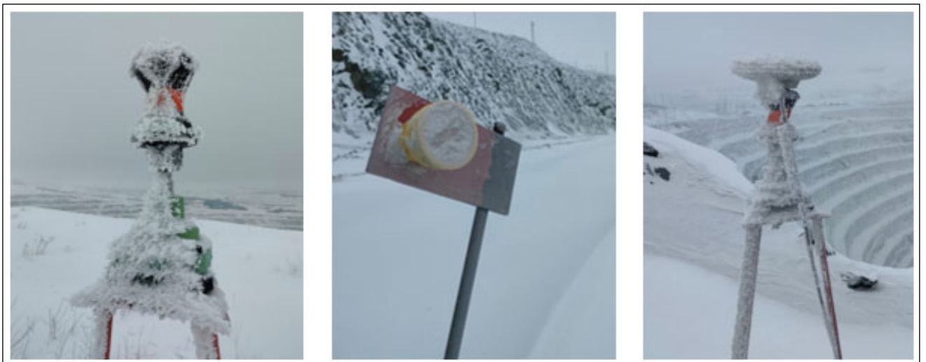
Рисунок 21 – Обледенение наблюдательных призм в условиях низких температур. Красноярский край
