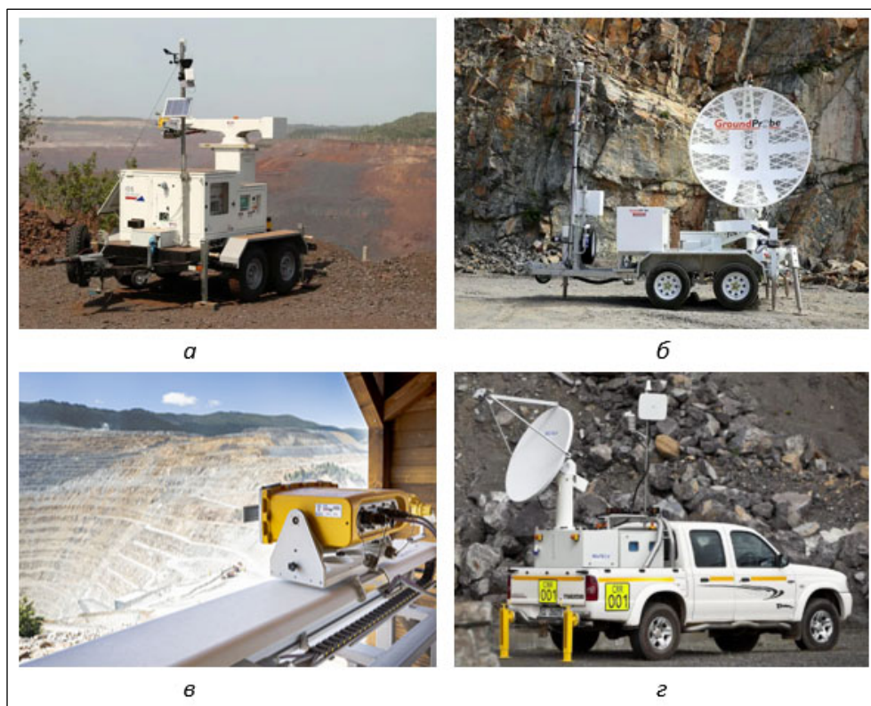
Рисунок 12 – Варианты исполнения наземных интерферометрических радаров:
