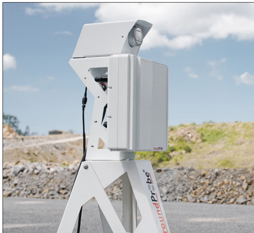
Рисунок 25 – Система отслеживания камнепадов и обвалов GroundProbe RDR-VELOX
