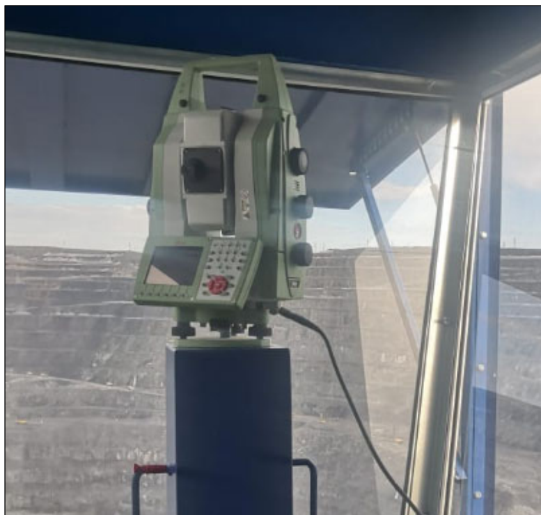
Рисунок 6 – Роботизированный электронный тахеометр Leica TM50, установленный в защитном укрытии на карьере
