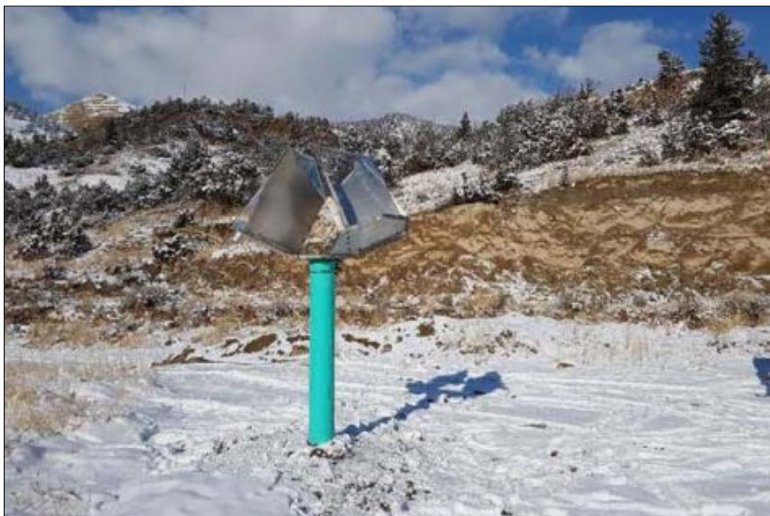
Рисунок 9 – Угловой отражатель, установленный на заснеженной территории
