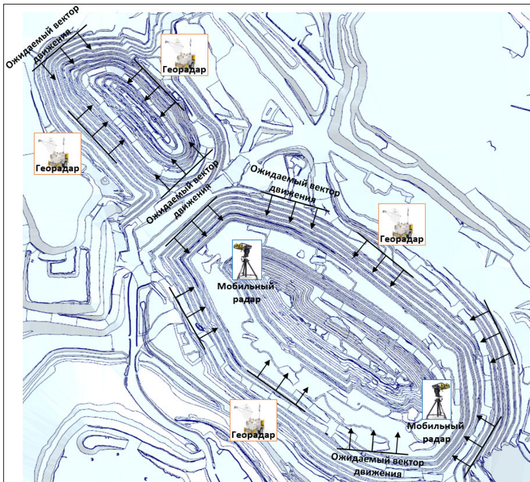
Рисунок 29 – Схема расположения радаров на карьере сложной формы
