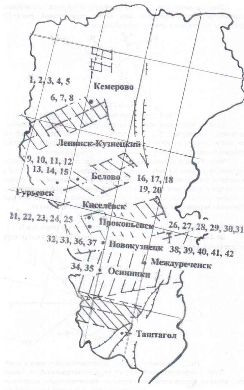
Рисунок 2.17 – Приуроченность шахт Кузбасса к зонам влияния разломов: номера шахт согласно их расположению в таблице 2.7; зоны влияния разломов заштрихованы
