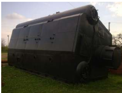
Рисунок 1 – Внешний вид водогрейного котла типа ДЕ 25/14
