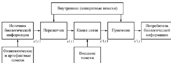
Рисунок 1 – Обобщённая схема передачи информации в БТМС
