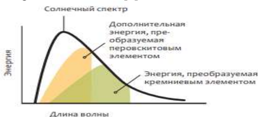
Рисунок 1 – Преобразование света перовскитом и кремнием в разных участках спектра
