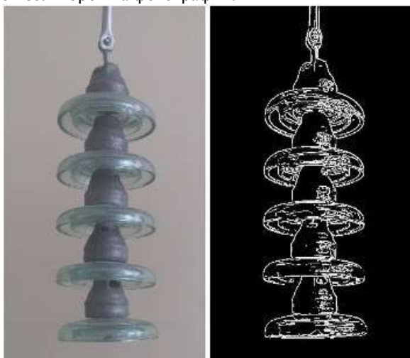
Рисунок 1 – Обработка фотографий гирлянд изоляторов
