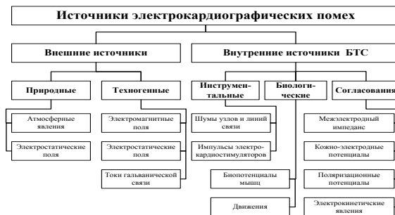
Рисунок 2 – Классификация электрокардиографических помех по источникам формирования
