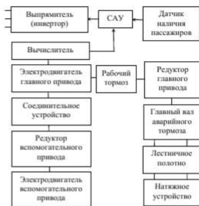
Рисунок 1 –Функциональная схема эскалатора
