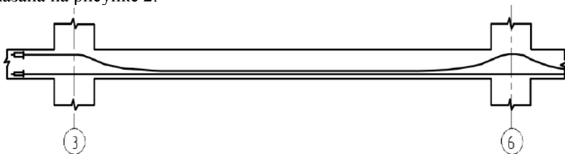
Рисунок 2 – Схема расположения предварительно напряженных канатов
