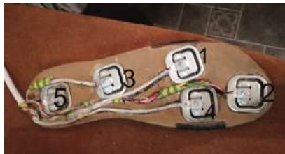
Рисунок 1 - Расположение датчиков на подошве
