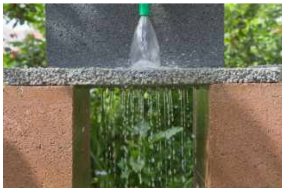
Рисунок 1 – Наглядная демонстрация технологии дренажного бетона, состоящей в создании материала, содержащего крупный заполнитель, при отсутствии мелкого заполнителя и недостаточном для заполнения пор и пустот количестве цементного теста
