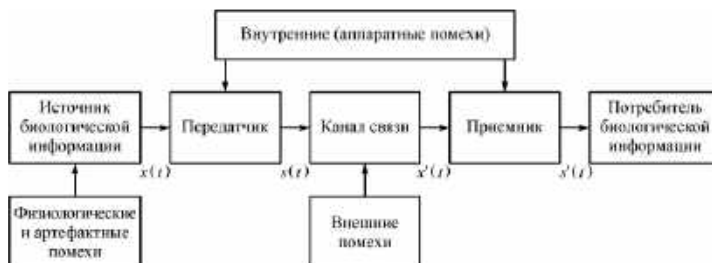
Рисунок 1 – Обобщенная схема передачи информации в БТМС
