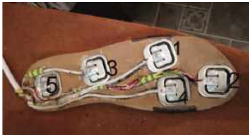
Рисунок 1 - Расположение датчиков на подошве
