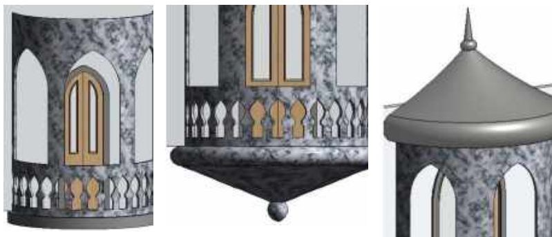
Рисунок 6 – Создание эркера на основе геометрии балкона
