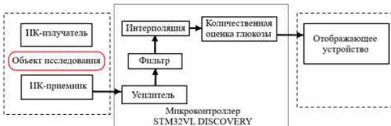
Рисунок 2 – Блок-схема концептуального глюкометра
