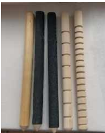
Рисунок 1 – Модели свай (слева направо): образец № 1, образец № 2, образец № 3, образец № 4, образец № 5
