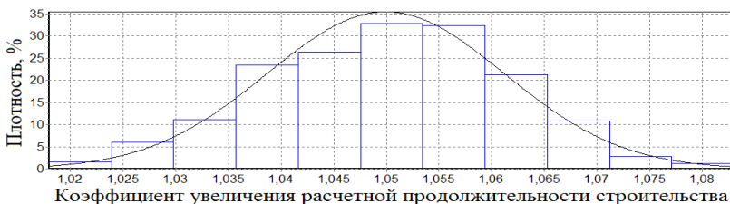
Рисунок 2 – Плотность распределения вероятностей коэффициента увеличения продолжительности строительства
