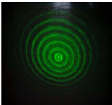
Рис. 1а. Светящиеся окружности лазерного излучения, сформированные дифракционным оптическим элементом
